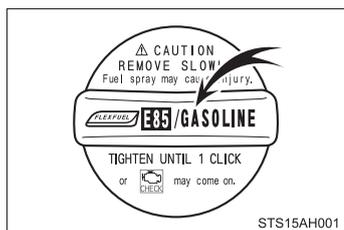
Un véhicule est à moteur Flex-fuel lorsque le bouchon du réservoir de carburant porte la mention “FLEXFUEL E85/GASOLINE”.
