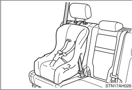
Ceintures de sécurité dotées d'un mécanisme de verrouillage de dispositif de retenue pour enfants (ceintures ALR/ELR, sauf celle du conducteur) (→P. 83)
