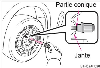
Serrez les écrous jusqu'à ce que la partie conique entre en contact lâche avec le siège du boulon dans la jante.
