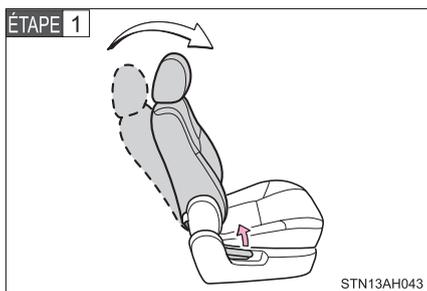
Tirez sur le levier de réglage de l'inclinaison du dossier de siège pour ramener celui-ci en position verticale.
