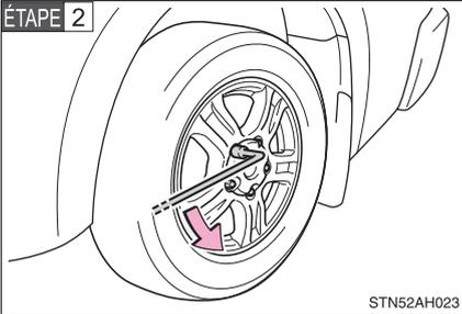
Desserrez légèrement les écrous de roue (un tour de clé).
