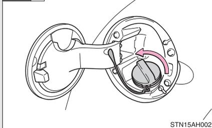
Pour ouvrir le bouchon du réservoir de carburant, tournez-le lentement.
