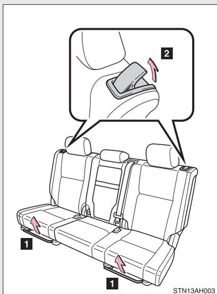
**1** Levier de réglage de position des sièges
