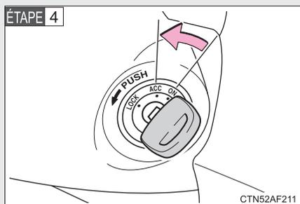
Coupez le moteur en plaçant le contacteur du moteur en position ACC.
