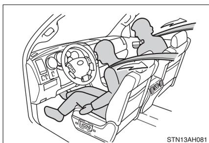
Le dispositif de tension sert à rétracter la ceinture de sécurité afin d'immobiliser rapidement l'occupant du véhicule en cas de collisions frontales importantes ou de tonneaux.
