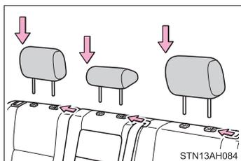
Alignez l'appui-tête sur les orifices d'installation puis abaissez-le en position de verrouillage.
