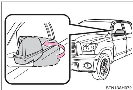
Pour rabattre les rétroviseurs, poussez-les vers l'arrière du véhicule.
