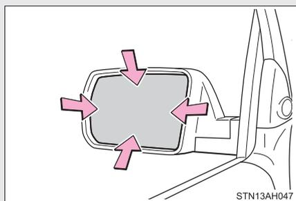
Réglez le rétroviseur vers le haut, le bas, l'intérieur ou l'extérieur, en appuyant sur sa surface.
