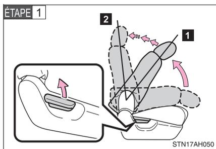
Rabattez le dossier et ramenez-le vers l'arrière, jusqu'à la 1<sup>ère</sup> position de verrouillage (la plus droite) jusqu'à ce qu'il s'enclenche. Réglez le dossier à la 13<sup>ème</sup> position de verrouillage. (→P. 62)
