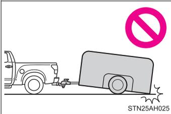
Quelle que soit sa classe d'attelage, pour que la remorque soit attachée en toute sécurité, sa boule doit être réglée à une hauteur convenant à son unité de couplage.
