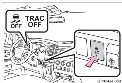
Arrêtez le véhicule complètement, et appuyez sur le contacteur VSC OFF pour plus de 3 secondes, lorsque le système est en mode AUTO LSD.
