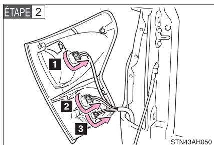
Tournez la base de l'ampoule dans le sens contraire à celui des aiguilles d'une montre.
