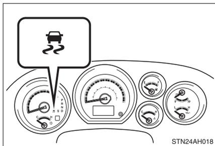
Si les roues arrière patinent, le témoin de dérapage clignote pour indiquer que le système AUTO LSD a contrôlé le patinage des roues arrière.
