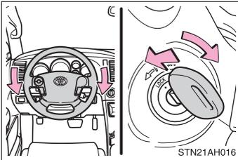
Lorsque vous faites démarrer le moteur, il se peut que le contacteur du moteur paraisse bloqué en LOCK. Pour le déverrouiller, tournez légèrement le volant de gauche à droite tout en tournant la clé.
