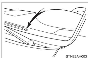
Il se peut que le capteur ne fonctionne pas adéquatement si l'on place un objet sur celui-ci ou si un objet fixé au pare-brise le bloque.
