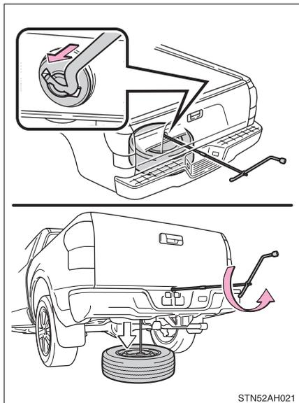
Insérez l'extrémité de la rallonge du cric dans la vis d'abaissement et tournez-la dans le sens antihoraire.
