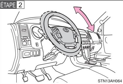
Réglez le volant à la position idéale en le déplaçant verticalement.
