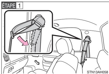
En position soulevée, poussez le dispositif de suspension de ceinture de sécurité aussi loin que possible vers le bas.
