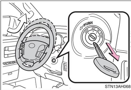
Lorsqu'on retire la clé du contacteur du moteur, le volant revient à sa position de repos en se déplaçant vers le haut et à l'écart du conducteur afin de faciliter l'entrée et la sortie de ce dernier.
