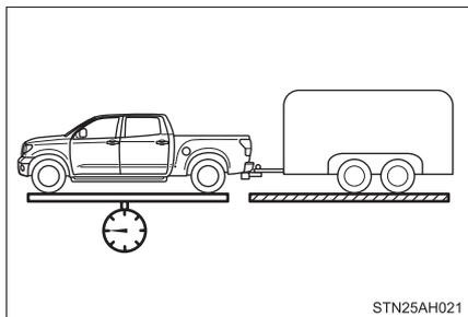
Le poids brut maximal permis pour le véhicule. Ce poids brut correspond au poids total du véhicule. Si l'on tracte une remorque, il représente la somme du poids du véhicule (y compris les occupants, les bagages et tout autre équipement facultatif installé sur le véhicule) et du poids au timon.
