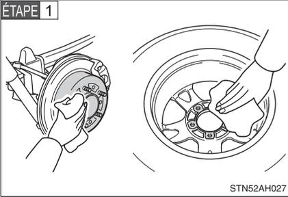
Retirez toute souillure ou corps étranger de la surface de contact de la roue.
