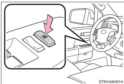
Appuyez sur le contacteur pour verrouiller les contacteurs des vitres des passagers.
