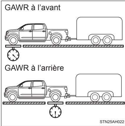
Le poids brut maximum permis sur les essieux. Le poids brut maximum sur essieu correspond à la charge sur chaque essieu (avant et arrière).
