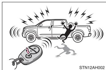
Si l'on appuie sur
