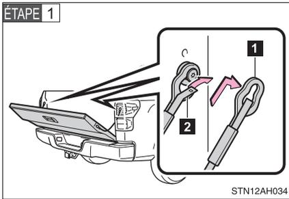
Ouvrez le hayon jusqu'à un angle où vous pouvez libérer les colliers de fixation sur les câbles de support des pattes sur les deux côtés.
