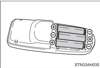
Retirez les piles à plat et remplacez-les par 3 piles AA neuves.
