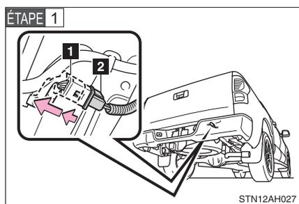
Pour débrancher les connecteurs (1 et 2) du faisceau de câblage, appuyez sur la petite languette de plastique du connecteur 1 et retirez celui-ci du connecteur 2.
