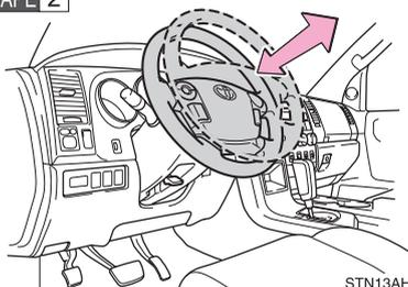
Réglez le volant à la position idéale en le déplaçant horizontalement.
