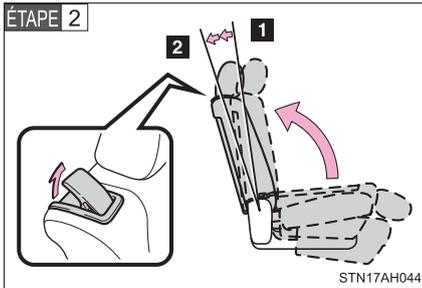
Rabattez le dossier et ramenez-le vers l'arrière, jusqu'à la 1<sup>ère</sup> position de verrouillage (la plus droite) jusqu'à ce qu'il s'enclenche. Réglez le dossier à la 8<sup>ème</sup> position de verrouillage. (→P. 64)
