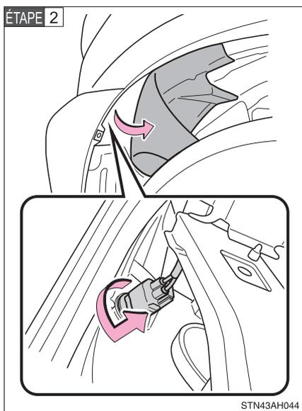
Retirez partiellement la doublure d'aile, puis tournez la base de l'ampoule dans le sens contraire à celui des aiguilles d'une montre.
