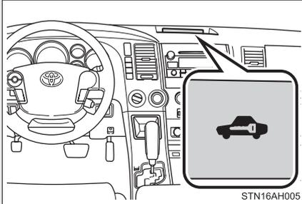
Si la clé de contact est retirée du contacteur du moteur, le témoin clignote pour indiquer que le système est en fonction.
