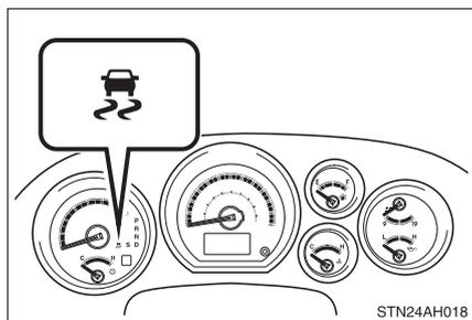
Si le véhicule menace de dérapier ou si les roues arrière (modèles 2WD et mode 2WD sur les modèles 4WD) ou toutes les roues (mode 4WD sur les modèles 4WD) patinent, la lampe témoin de dérapage clignote pour indiquer que les systèmes VSC/contrôle de tangage de remorque/TRAC/A-TRAC ont été activés.
