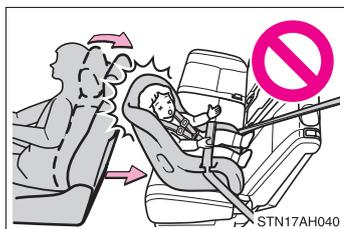
● Modèles à Double Cab et CrewMax: Si le siège du conducteur entrave le dispositif de retenue pour enfants ou ne permet pas de fixer celui-ci convenablement, fixez le dispositif au siège arrière droit.
