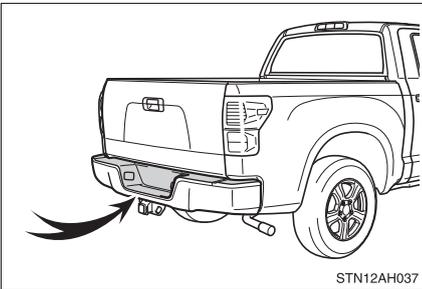
Sert à protéger l'arrière du véhicule et à faciliter le chargement par l'arrière.
