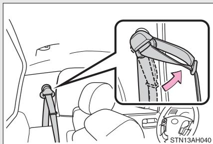
Soulevez le dispositif de suspension de ceinture de sécurité avant jusqu'à ce qu'il se verrouille.
