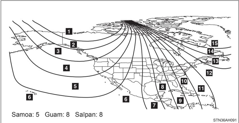
La direction indiquée dévie de la direction réelle déterminée par le champ magnétique terrestre. L'importance de cette déviation varie en fonction de la position géographique du véhicule.
