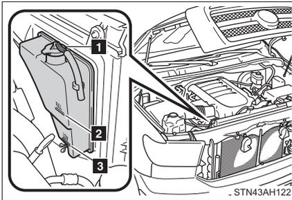
**1** Bouchon du réservoir
