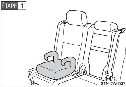
Placez le siège de rehausse sur un siège, face à la route.
