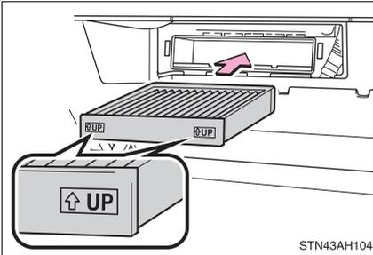
Retirez le filtre du climatiseur et remplacez-le par un filtre neuf.
