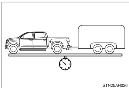
Le poids brut combiné maximal permis. Le poids brut combiné est la somme de poids brut de véhicule (y compris les occupants, charge et tous équipements optionels installés) et de poids de remorque (y compris la charge dans le remorque).
