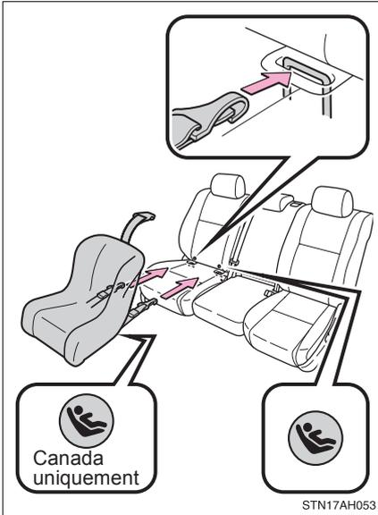
**ÉTAPE 2** Fixez les crochets des sangles inférieures aux ancrages LATCH et tendez les sangles inférieures.
