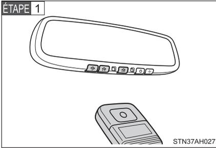
Pointez la télécommande transmetteur du dispositif vers les touches de commande du HomeLink®, à une distance d'environ 1 à 3 in. (25 à 75 mm).
