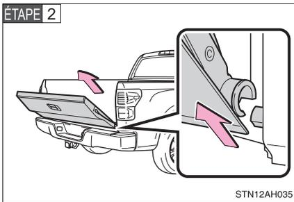
Inclinez le hayon à environ 45° de la verticale et soulevez le côté droit du hayon pour décrocher le côté droit.
