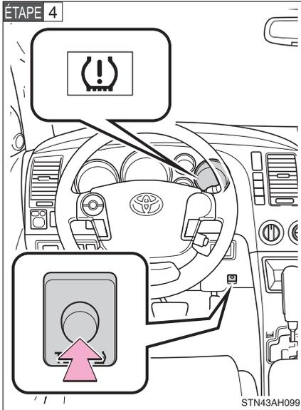
Maintenez le commutateur de remise à zéro du système témoin de basse pression des pneus enfoncé jusqu'à ce que la lampe témoin de pression des pneus clignote lentement 3 fois.
