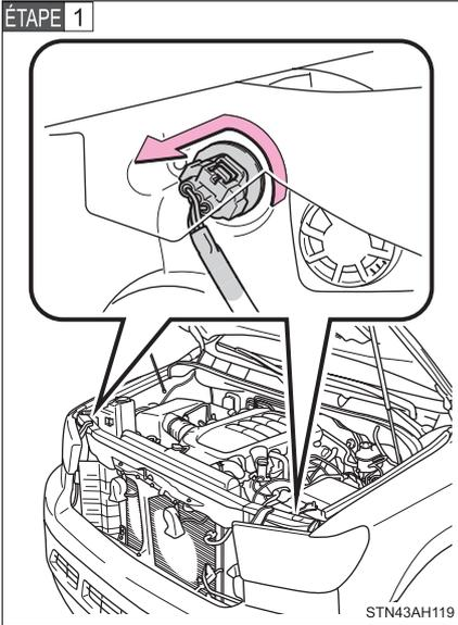
Tournez la base de l'ampoule dans le sens contraire à celui des aiguilles d'une montre.
