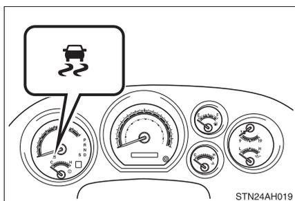
Si le véhicule menace de dérapier ou si les roues arrière (modèles 2WD et mode 2WD sur les modèles 4WD) ou toutes les roues (mode 4WD sur les modèles 4WD) patinent, le témoin de dérapage clignote pour indiquer que le système VSC/TRAC/A-TRAC a été activé.
