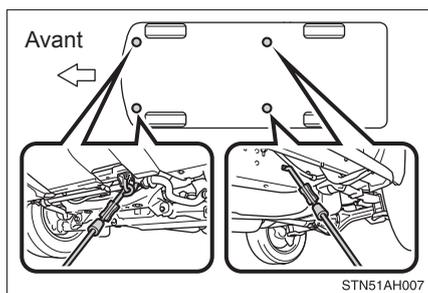
Si votre Toyota est transportée sur une dépanneuse à plateau, elle doit être arrimée en utilisant les points d'arrimage illustrés ci-contre.
