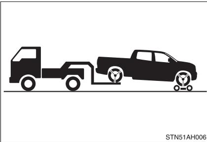
Nous recommandons de placer un panier remorque sous les roues avant.
