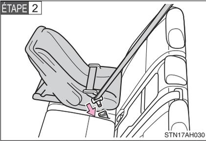
Passez la ceinture dans le siège de bébé et insérez la languette dans la boucle. Assurez-vous que la ceinture n'est pas tournée.
