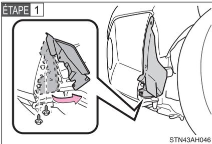
Retirez les boulons et retirez partiellement la doublure d'aile.
