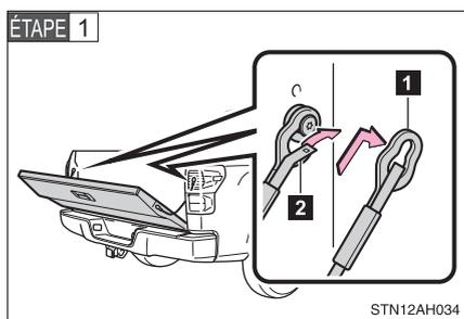
Ouvrez le hayon jusqu'à un angle où vous pouvez libérer les colliers de fixation sur les câbles de support des pattes sur les deux côtés.
