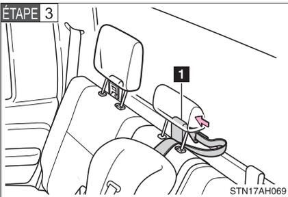
Faites passer la courroie supérieure par le dispositif de guidage, comme indiqué sur le schéma.
