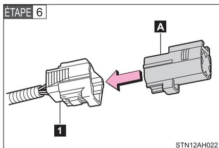
Fixez le couvercle (Gris) sur le connecteur du faisceau de câblage du hayon (Blanc).
