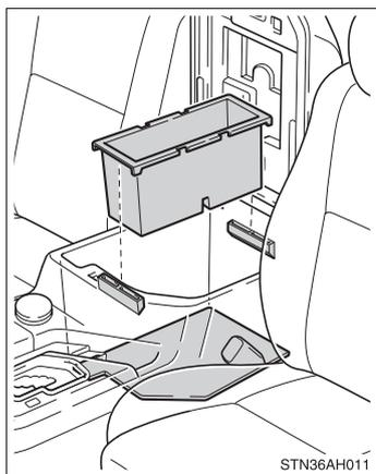
Le compartiment peut être retiré. On peut suspendre des dossiers aux rails lorsque le compartiment a été retiré.
