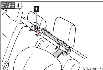
Fixez le crochet à l'anneau de tresse d'ancrage intérieur et tendez la courroie supérieure.
