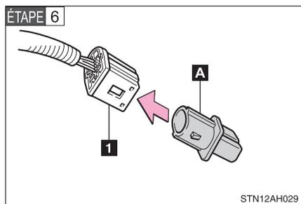
Fixez le couvercle de connecteur de faisceau de câblage de hayon arrière sur le connecteur de faisceau de câblage de hayon arrière.
