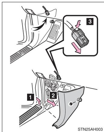
Le véhicule est équipé d'un connecteur électrique pour le contrôleur de freins de remorquage, tel qu'illustré.
