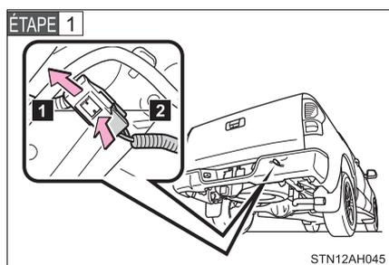
Pour débrancher les connecteurs du faisceau de câblage (**1** et **2**), maintenez enfoncé le verrou du connecteur (Blanc) du faisceau de câblage du hayon, puis détachez-le.
