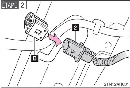
Fixez le couvercle de connecteur de faisceau de câblage de châssis sur le connecteur du faisceau de câblage de châssis.
