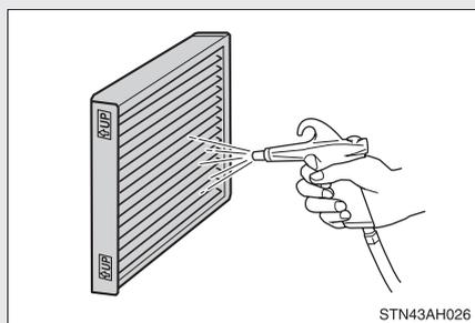
Si le filtre est encrassé, nettoyez-le en dirigeant un jet d'air comprimé sur le côté arrière du filtre.
