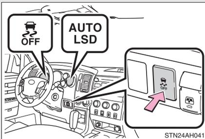
Arrêtez le véhicule complètement, et appuyez sur le contacteur VSC OFF pour plus de 3 secondes.
