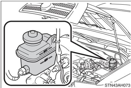
Le niveau du liquide de frein doit se situer entre les repères MAX et MIN du réservoir.
