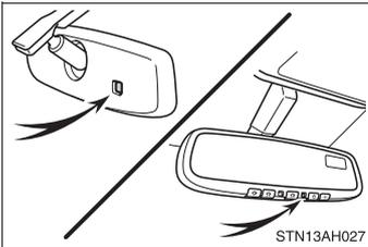
Pour assurer le fonctionnement adéquat des capteurs, ne les touchez pas et ne les recouvrez pas.
