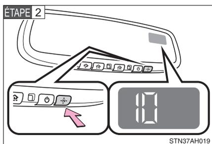
Appuyez sur le contacteur jusqu'à ce qu'un chiffre (1 à 15) s'affiche sur la boussole.
