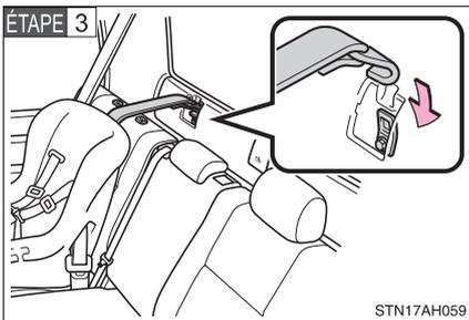
Fixez le crochet au support d'ancrage et tendez la courroie supérieure.
