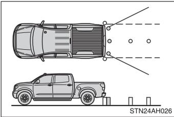
La zone d'image couverte par le moniteur est limitée. Les objets proches des coins du pare-chocs ou situés sous le pare-chocs ne sont pas visibles à l'écran.
