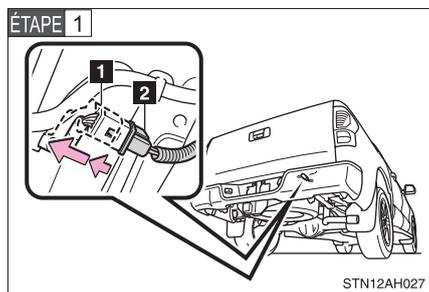
Pour débrancher les connecteurs du faisceau de câblage (**1** et **2**), le connecteur de faisceau de câblage de hayon arrière, détachez-les.
