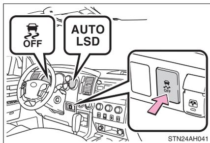
Arrêtez le véhicule complètement, et appuyez sur le contacteur VSC OFF pour plus de 3 secondes, lorsque le système est en mode TRAC OFF.
