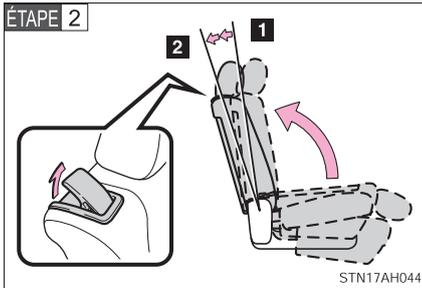
Rabattez le dossier et ramenez-le vers l'arrière, jusqu'à la première position de verrouillage (la plus droite) jusqu'à ce qu'il s'enclenche. Réglez le dossier à la 8ème position de verrouillage. (→P. 67)
