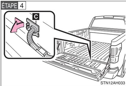
Retirez le protecteur en plastique des câbles situés dans la caisse du véhicule en appuyant sur les languettes puis en tirant sur le protecteur.
