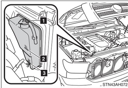
**1** Bouchon du réservoir
