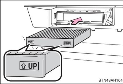
Retirez le filtre du climatiseur et remplacez-le par un filtre neuf.
