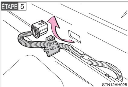
Retirez le faisceau de câblage de la caisse du véhicule.
