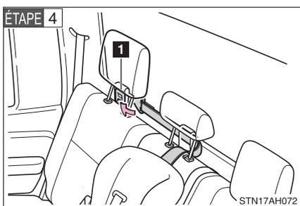
Fixez le crochet à l'anneau de tresse d'ancrage intérieur et tendez la courroie supérieure.
