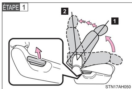
Rabattez le dossier et ramenez-le vers l'arrière, jusqu'à la première position de verrouillage (la plus droite) jusqu'à ce qu'il s'enclenche. Réglez le dossier à la 13ème position de verrouillage. (→P. 65)
