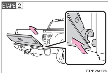
Inclinez le hayon à environ 45° de la verticale et soulevez le côté droit du hayon pour décrocher le côté droit.
