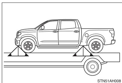
Si vous utilisez des chaînes ou des câbles pour arrimer votre véhicule, les angles indiqués par des triangles doivent être de 45°.
