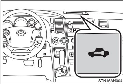
Si la clé de contact est retirée du contacteur du moteur, le voyant clignote pour indiquer que le système est en fonction.
