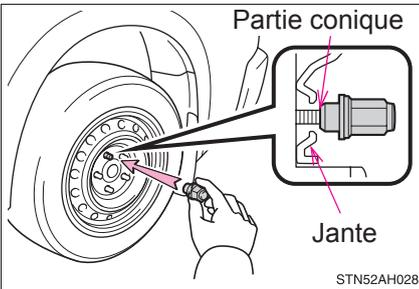
Serrez les écrous jusqu'à ce que la partie conique entre en contact lâche avec le siège du boulon dans la jante.
