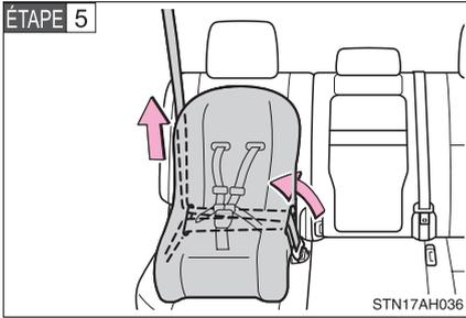
Tout en poussant le siège de bébé au fond du siège, laissez la ceinture épaulière s'enrouler jusqu'à ce que le siège soit bien en place.
