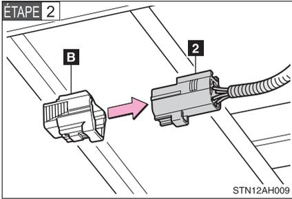
Fixez le couvercle (Blanc) sur le connecteur du faisceau de câblage du châssis (Gris).
