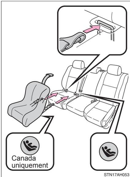
**ÉTAPÉ 2** Fixez les crochets des sangles inférieures aux ancrages LATCH et tendez les sangles inférieures.
