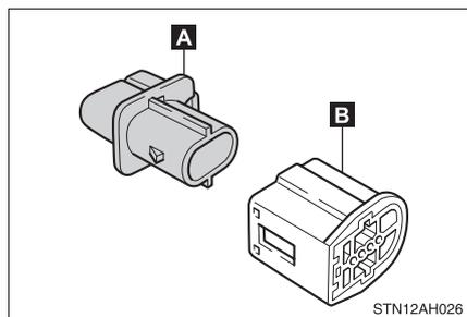
**A** Couvercle de connecteur de faisceau de câblage du hayon arrière
