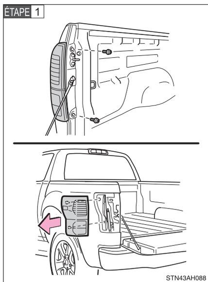
Retirez les boulons et le module des feux arrière.
