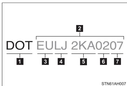
**1** Symbole DOT\***2** Numéro d'identification du pneu (TIN)**3** Symbole d'identification du fabricant**4** Code de dimension du pneu**5** Code optionnel du fabricant relatif au type de pneu (3 ou 4 lettres)**6** Semaine de fabrication**7** Année de fabrication
