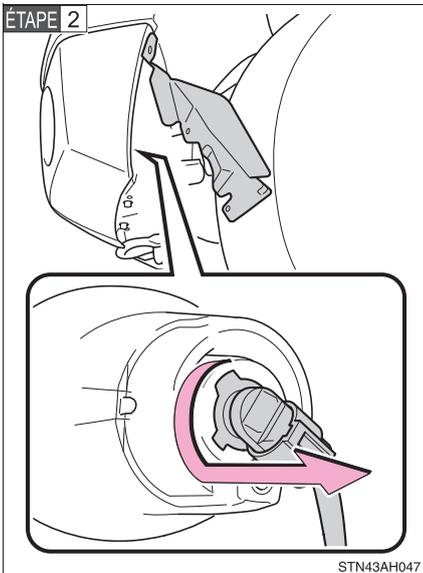
Tournez l'ampoule dans le sens contraire à celui des aiguilles d'une montre.
