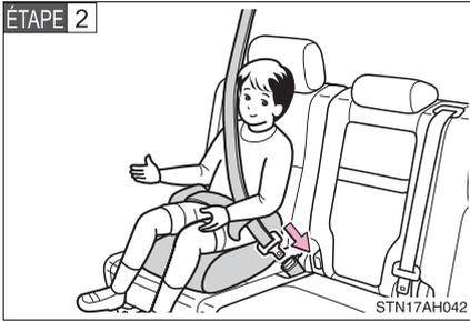
Asseyez l'enfant dans le siège de rehausse. Fixez la ceinture de sécurité sur le siège de rehausse conformément aux directives du fabricant, puis insérez la languette dans la boucle. Assurez-vous que la ceinture n'est pas tournée.
