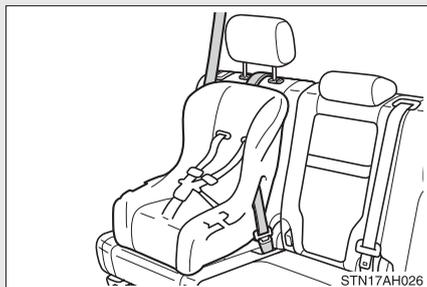
Ceintures de sécurité dotées d'un mécanisme de verrouillage de dispositif de retenue pour enfants (ceintures ALR/ELR, sauf celle du conducteur) (→P. 80)
