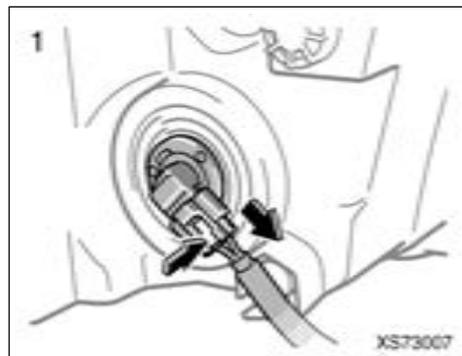
**1. Ouvrez le capot. Débranchez le connecteur tout en appuyant sur le dispositif de déverrouillage.**
