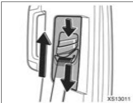
**Ceintures de sécurité avec point d'ancrage supérieur réglable (modèles Double cab et Crew Max)—**
