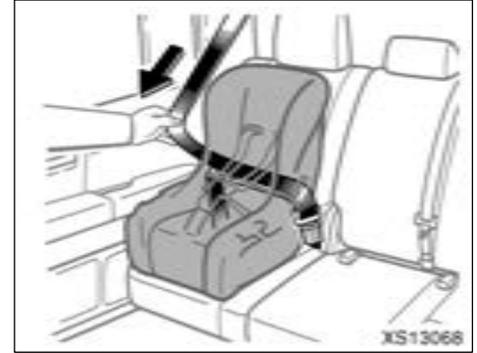
2. Déroulez au maximum la sangle diagonale pour amener la ceinture de sécurité en mode verrouillage. Lorsque la ceinture est rétractée même légèrement, elle ne peut plus être déroulée.
