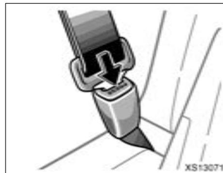
3. Appuyez fermement le siège modulable contre l'assise et le dossier de siège, laissez la sangle diagonale s'enrouler au maximum pour que le siège combiné soit parfaitement fixé.
