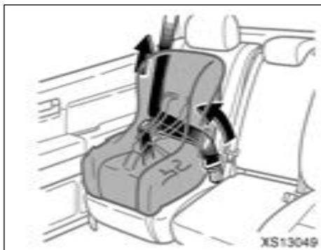
3. Appuyez fermement le siège modulable contre le coussin et le dossier de siège, laissez la sangle diagonale s'enrouler au maximum pour que le siège combiné soit parfaitement fixé.
