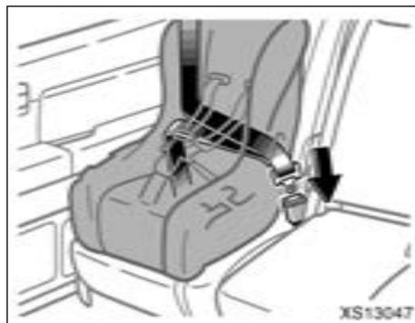
● **Banquette:** Pour fixer fermement le système de retenue pour enfant sur le siège avant central, alignez l'inclinaison du dossier et la position du siège avant droit sur celles du siège avant central. Si le système de retenue pour enfant ne peut être fermement fixé sur le siège, installez-le sur le siège avant droit. Sinon, cela risque d'entraîner des blessures graves, voire mortelles, en cas d'accident.
