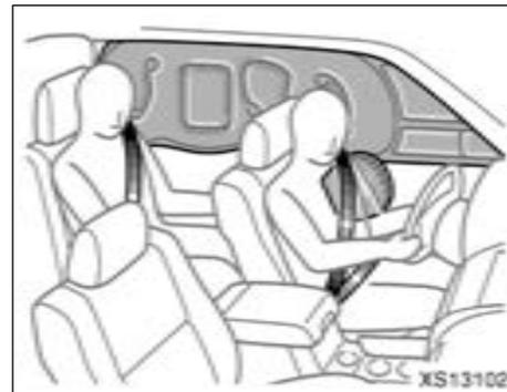
**Les coussins de sécurité latéraux et coussins de sécurité rideaux SRS (système de retenue supplémentaire) sont conçus pour offrir une protection supplémentaire au conducteur et à tous les passagers se trouvant à proximité d'une vitre, outre la protection principale offerte par les ceintures de sécurité.**
