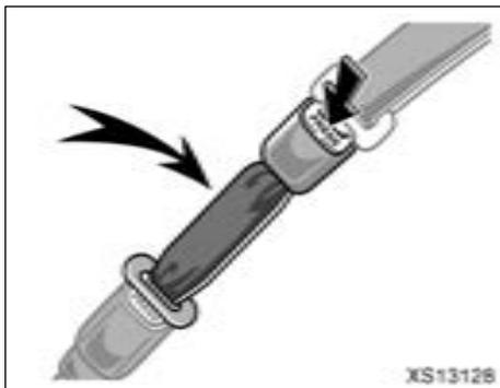
Pour relier la rallonge à la ceinture de sécurité, introduisez la languette dans la boucle de ceinture jusqu'à ce que les boutons de déverrouillage "PRESS" de la rallonge et de la ceinture soient orientés vers l'extérieur comme illustré.
