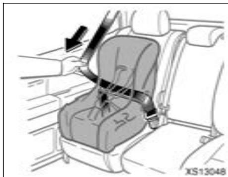
2. Déroulez au maximum la sangle diagonale pour amener la ceinture de sécurité en mode verrouillage. Lorsque la ceinture est rétractée même légèrement, elle ne peut plus être déroulée.
