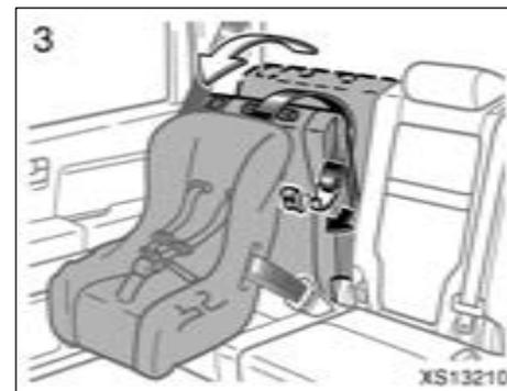
3. Tirez sur le levier de déverrouillage du dossier de siège et basculez le dossier légèrement vers l'avant puis verrouillez le crochet au point d'ancrage. Ramenez le dossier à sa position initiale.
