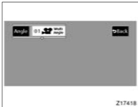
L'angle de vue peut être sélectionné pour les disques compatibles multi-angles lorsque le symbole " " apparaît à l'écran. L'angle de vue change à chaque pression sur le contacteur "Angle". Le numéro d'angle que vous pouvez sélectionner apparaît à l'écran.
