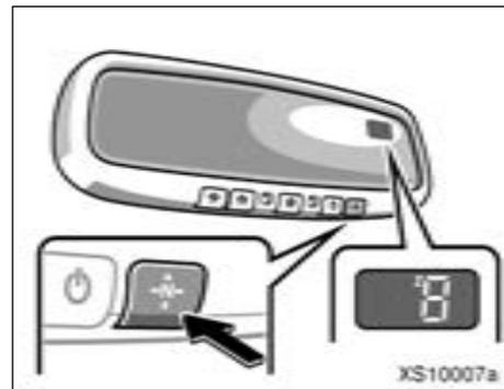
**ETALONNAGE DE LA BOUSSOLE (étalonnage du décalage angulaire)**
