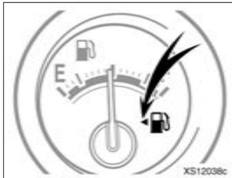
Ceci indique que la trappe de remplissage de carburant se trouve sur le côté gauche de votre véhicule.
