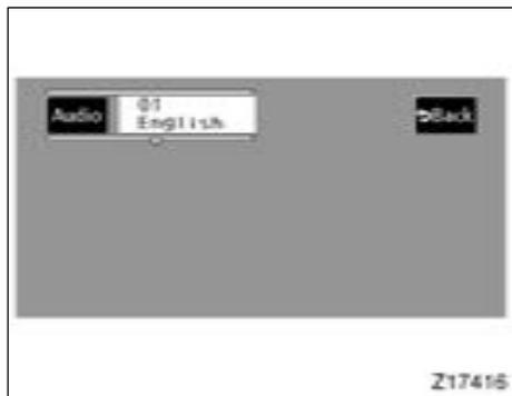
Chaque sélection du contacteur “Audio” fait défiler les langues contenues dans le disque sélectionné.
