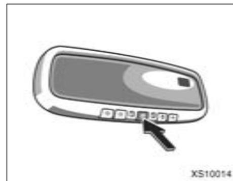
5. Testez le fonctionnement de la commande HomeLink® en appuyant sur la touche nouvellement programmée. Si vous programmez une commande d'ouverture de porte de garage, vérifiez que cette dernière s'ouvre et se ferme.
