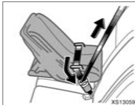
3. Appuyez fermement le siège bébé contre l'assise et le dossier de siège, laissez la sangle diagonale s'enrouler au maximum pour que le siège bébé soit parfaitement maintenu.
