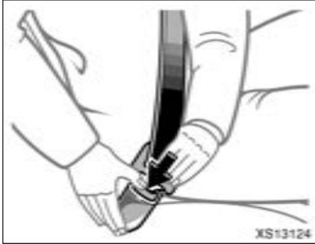
**Pour détacher la ceinture, appuyez sur le bouton de déverrouillage de la boucle et laissez la ceinture se réenrouler.**
