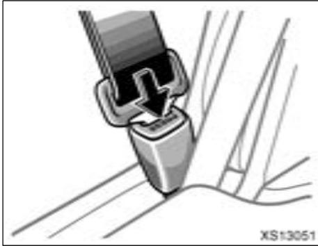
Pour enlever le coussin de rehausse: Appuyez sur le bouton de déverrouillage de la boucle et laissez la ceinture se réenrouler complètement.
