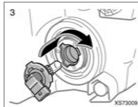
**3. Branchez une nouvelle ampoule puis posez-la dans l'orifice de fixation.**
