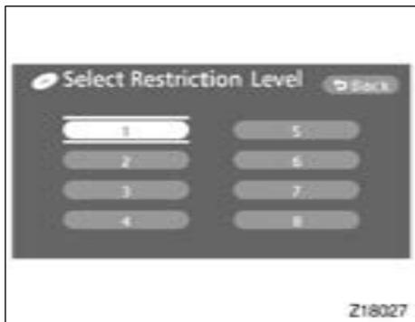
Sélectionnez un niveau de restriction (de 1—8). Plus le numéro est petit, plus le niveau de restriction est élevé. Appuyez sur le contacteur “Back” pour revenir à l’écran “Setup Menu”.
