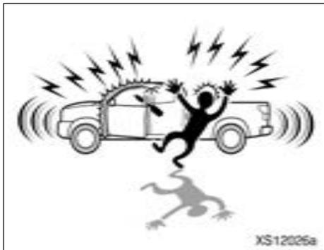
Le système fait retentir l'alarme et fait clignoter les phares lorsqu'une ouverture forcée est détectée. L'alarme se déclenche lorsque le déverrouillage ou l'ouverture forcée d'une porte ou du capot est détecté ou bien lorsque la borne de la batterie est débranchée puis rebranchée alors que le véhicule est verrouillé.
