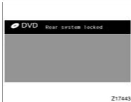
Lorsque le verrouillage du système arrière est activé et qu'on appuie sur une touche de la télécommande ou sur la console, l'écran ci-dessus s'affiche pendant 6 secondes environ.
