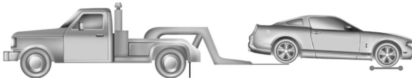
Lors du remorquage de la Shelby GT500, et que le véhicule est embarqué par l'avant, les pneus avant doivent être surélevés de 41 cm (16 po) par rapport aux pneus arrière.
