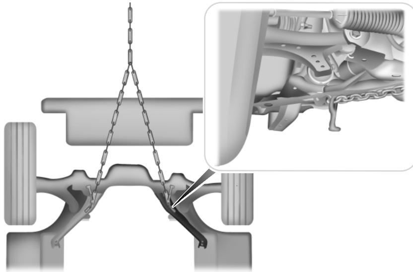
Lors du remorquage du véhicule, assurez-vous d'utiliser deux crochets en J miniatures, puis fixez-les aux trous oblongs de la traverse, comme il est illustré, pour placer le véhicule sur la plate-forme. La fente de crochet en T doit être utilisée pour arrimer le véhicule à la dépanneuse. D'autres méthodes peuvent causer des dommages au véhicule.
