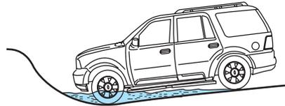
Après avoir traversé un plan d'eau, essayez toujours les freins, car des freins humides ne sont pas aussi efficaces que des freins secs. Pour accélérer le séchage des freins, freinez doucement à quelques reprises tout en roulant à basse vitesse.
