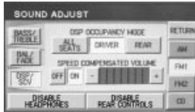
**Touche DSP (traitement numérique du signal, mode de distribution du son) :** Cette touche permet d'optimiser le son en fonction des occupants du véhicule. Choisissez entre ALL SEATS (tous les sièges), REAR SEATS (sièges arrière) et DRIVER SEAT (siège du conducteur).
