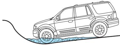
Après avoir traversé la nappe d'eau, essayez toujours vos freins car des freins humides ne sont pas aussi efficaces que des freins secs. Pour accélérer le séchage des freins, freinez doucement à quelques reprises tout en roulant à basse vitesse.
