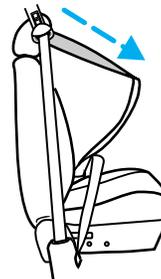
3. Laissez la sangle se rétracter. Pendant que la sangle se rétracte, des déclics se font entendre. Ces déclics indiquent que l'enrouleur est en mode de blocage automatique.
