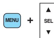
Appuyez sur la touche MENU jusqu'à ce que le mode de fonction de compression soit affiché au guichet. Lorsque le message COMPRESS OFF (compression hors fonction) s'affiche au guichet de la radio, appuyez sur la touche SEL (sélection) pour activer la fonction de compression. Pour désactiver la fonction de compression, appuyez de nouveau sur la touche SEL lorsque le message COMPRESS ON (compression en fonction) est affiché.
