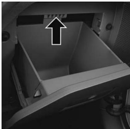
Dispositif d'arrêt du déplacement de la boîte à gants
