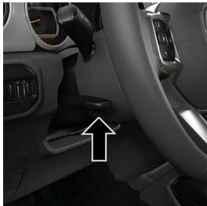
Levier d'inclinaison et de réglage télescopique de la colonne de direction
