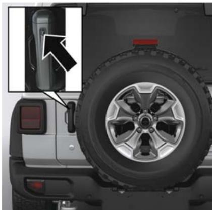
Emplacement du système de déverrouillage passif de la porte pivotante
