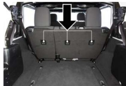
**Ancrages de courroie d'attache
