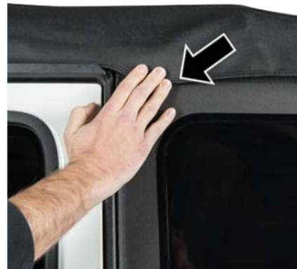
**Fixez fermement l'attache à crochets et boucles**
