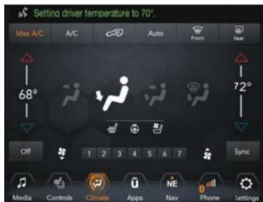
**Menu Chauffage-climatisation du système Uconnect 4C/4C AVEC NAVIGATION avec affichage de 8,4 pouces**
