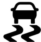
Ce témoin s'allume constamment lorsque le système de traction asservie est désactivé. Ce témoin clignote lorsque le système de traction asservie est activé.
