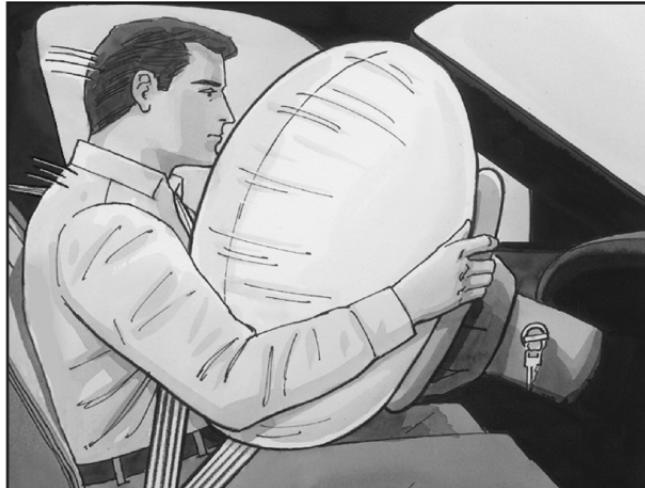
Le sac gonflable avant du conducteur se trouve au milieu du volant de direction.
