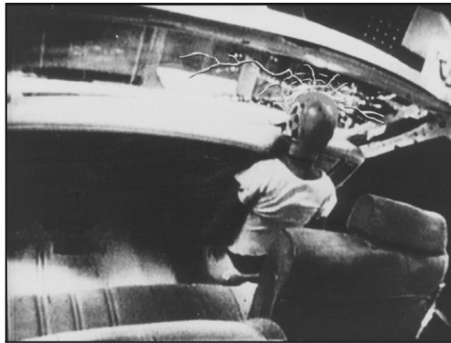
Ce passager poursuivra sa course jusqu'à ce qu'il soit arrêté par quelque chose. Dans un vrai véhicule, cela pourrait être le pare-brise...
