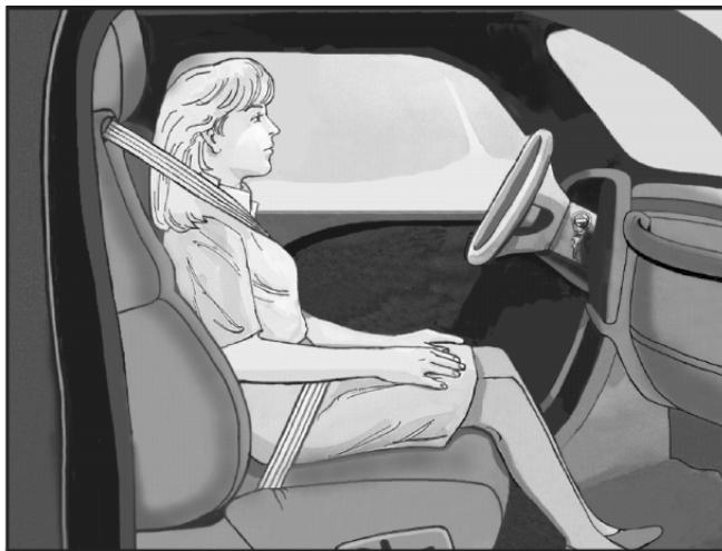
Les ceintures de sécurité contribuent à maintenir le passager en position dans le siège pendant les manœuvres du véhicule et le freinage. Ceci aide le système de détection de passager à maintenir le statut de sac gonflable de passager. Se reporter à « Ceintures de sécurité » et « Dispositifs de protection d'enfant », dans l'index, pour plus d'informations au sujet de l'importance de l'utilisation correct du dispositif de protection d'enfant.
