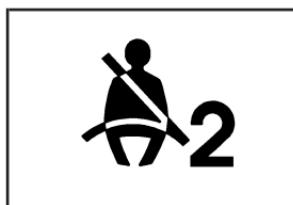
Ce carillon et ce témoin se déclenchent à nouveau si le passager ne boucle pas sa ceinture de sécurité et que le véhicule se déplace.
