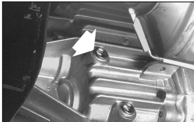
1. Retirer le bouchon de l'orifice de remplissage.
