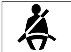
De plus, le témoin de rappel de bouclage des ceintures de sécurité s'allume et reste allumé pendant quelques secondes, puis il clignote pendant quelques secondes.
