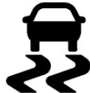
Si votre véhicule est équipé du système StabiliTrak<sup>MD</sup>, ce témoin s'allume lorsque le système StabiliTrak<sup>MD</sup> est désactivé.
