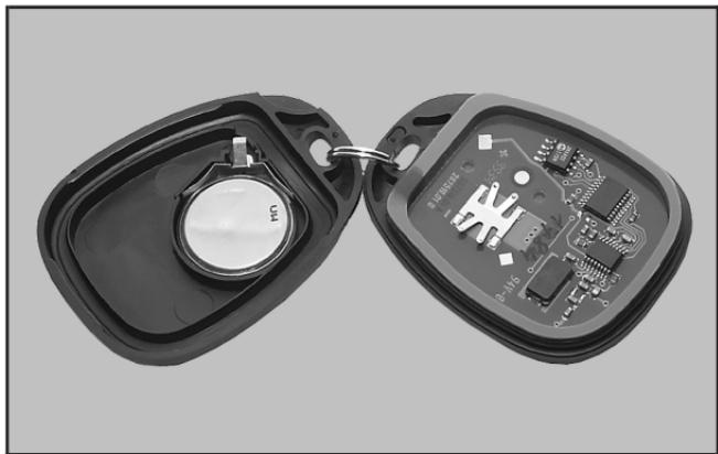
1. Ouvrir l'émetteur en deux en utilisant un objet plat et fin à insérer dans la fente entre les deux moitiés du logement du transmetteur.
