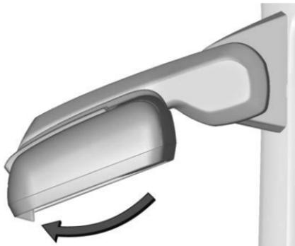
**Déploiement manuel :** Selon l'équipement, saisir fermement le boîtier de rétroviseur et tirer d'un coup dans un mouvement circulaire vers l'arrière du véhicule.
