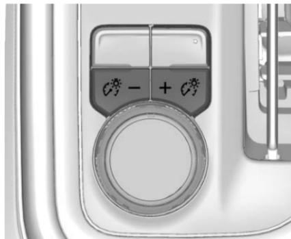
Ce dispositif contrôle l'intensité de l'éclairage du volant et du tableau de bord. La commande d'éclairage du tableau de bord se trouve près de la commande d'éclairage extérieur.
