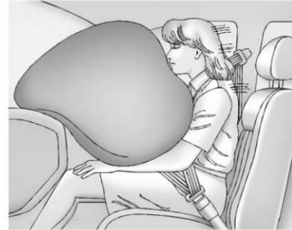
Le sac gonflable avant de passager avant extérieur se trouve dans le tableau de bord du côté passager.
