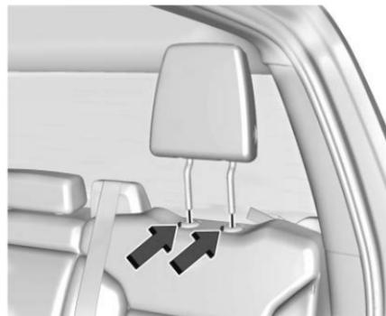
1. Appuyer simultanément sur les deux boutons des tiges d'appuie-tête ou de repose-tête, puis le tirer vers le haut.
