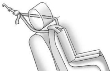
Si la position que vous utilisez dispose d'un appui-tête réglable et que vous utilisez une attache double, faire passer l'attache autour de l'appui-tête.
