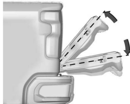
Pour fermer le hayon à l'aide de la fonction soulever pour fermer, soulever le hayon depuis la position complètement ouverte jusqu'à au moins 10 cm (4 po) et le maintenir momentanément. Ensuite, le hayon se fermera automatiquement. Si le hayon est soulevé au-delà de mi-parcours entre l'ouverture et la fermeture, il ne se fermera pas automatiquement.
