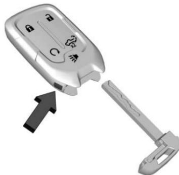
Retirer la clé en pressant le bouton sur le côté de l'émetteur RKE près de la base. Ne jamais retirer la clé sans presser le bouton.
