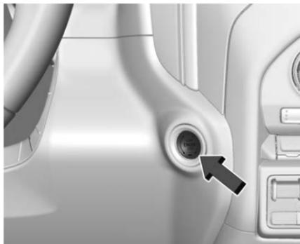
Les véhicules équipés d'un accès sans clé possèdent un démarrage à bouton-poussoir.
