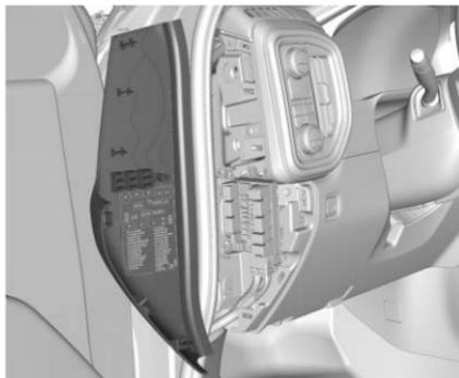
Le volet d'accès au bloc-fusibles du côté gauche est sur le tableau de bord, côté conducteur.
