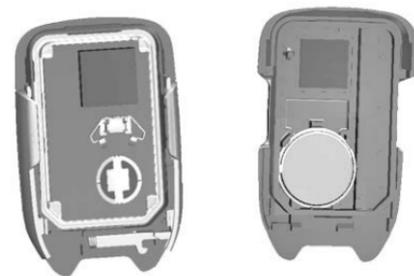
3. Soulever la pile au moyen d'un objet plat.
