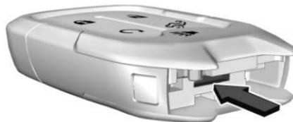
2. Introduire un objet plat et mince au centre de l'émetteur pour les séparer et déposer le couvercle du dos.
