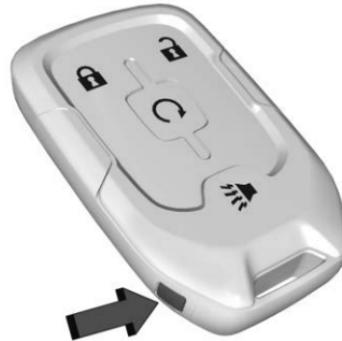
Si le véhicule est équipé d'un système d'accès sans clé, la partie inférieure de l'émetteur comporte un bouton sur le côté pour extraire la clé.
