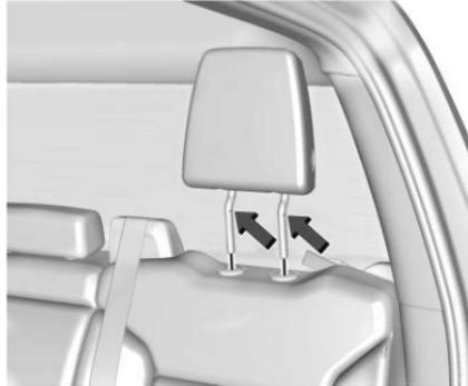
1. Insérer les montants de l'appuie-tête ou du repose-tête dans les trous en haut du dossier du siège. Les encoches sur les montants doivent être orientées vers le côté conducteur du véhicule.
