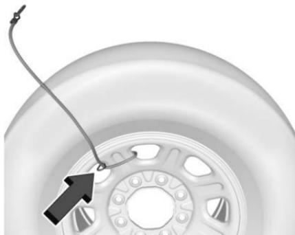
1. Si le véhicule est équipé d'un câble de roue de secours, réinstaller le câble sur la roue de secours en enroulant le câble autour d'une fenêtre d'aération de la roue, puis faites passer l'extrémité du câble du clip à travers la boucle. L'excès de câble doit se trouver du côté de la tige de valve de la roue de secours.
