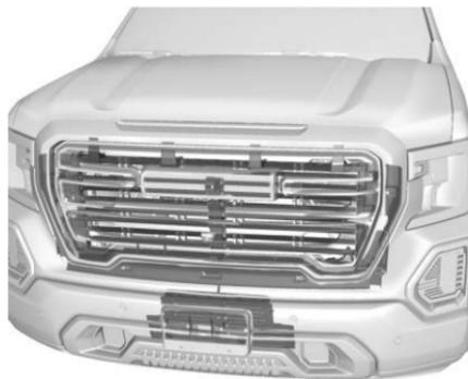
Le véhicule peut être équipé d'un système d'obturateur conçu pour aider à améliorer l'économie de carburant. Garder le système d'obturateur propre pour un fonctionnement correct.
