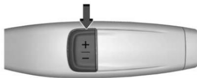
Ce mode contribue à commander la boîte de vitesses et la vitesse du véhicule en montagne ou lors de la traction d'une remorque en vous permettant de sélectionner une plage désirée de rapports.
