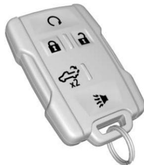
**⏻** : Appuyer sur **🔒** et le relâcher, puis immédiatement presser et maintenir **⏻** enfoncé jusqu'à ce que les feux clignotent pendant au moins quatre secondes. Le moteur peut être démarré depuis l'extérieur du véhicule au moyen de l'émetteur RKE. Voir *Démarrage à distance du véhicule* ⇨ 24.
