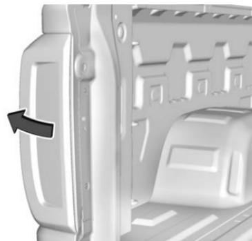
4. Tirer l'ensemble du feu arrière vers l'extérieur et vers l'arrière du côté de la caisse pour le retirer du véhicule.
