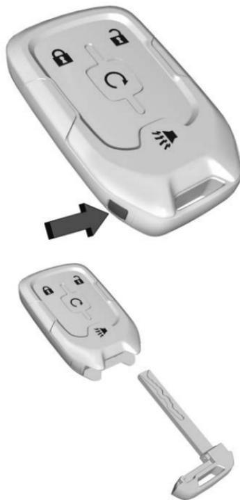
1. Appuyer sur le bouton de l'émetteur de télédéverrouillage pour retirer la clé. Ne jamais retirer la clé sans appuyer sur le bouton.
