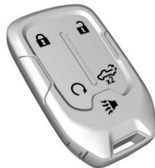
🔓 : Appuyer sur 🔒 et le relâcher, puis immédiatement presser et maintenir 🔓 enfoncé jusqu'à ce que les feux clignotent pendant au moins quatre secondes. Le moteur peut être démarré depuis l'extérieur du véhicule au moyen de l'émetteur RKE. Voir *Démarrage à distance du véhicule* ⇨ 24.
