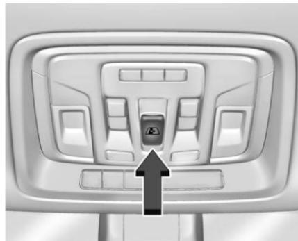
Selon l'équipement, les glaces arrière coulissantes électriques fonctionnent lorsque le contact est allumé ou en position ACC/ACCESSORY (accessoires) ou la prolongation de l'alimentation des accessoires (RAP) doit être active. Se reporter à *Prolongation d'alimentation des accessoires* ↷ 250.
