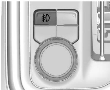
Selon l'équipement, la commande des feux antibrouillard se trouve à proximité de la commande de feux extérieur, à gauche de la colonne de direction.
