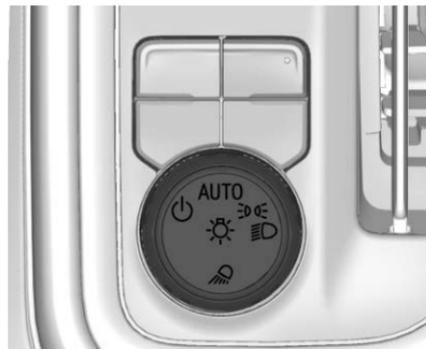
La commande d'éclairage extérieur se trouve sur le tableau de bord, à gauche du volant.
