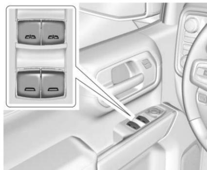
Les lève-vitres électriques fonctionnent lorsque le contact est mis, en position ACC/ACCESSORY (accessoires) ou lorsque la prolongation de l'alimentation des accessoires (RAP) est active. Se reporter à *Prolongation d'alimentation des accessoires* ↪ 250.
