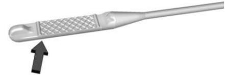
Si le niveau d'huile se situe au-dessous de la section quadrillée de la pointe de la jauge et que le moteur est éteint depuis au moins 15 minutes, ajouter 1 litre d'huile (1 pt) préconisée et vérifier encore le niveau. Se reporter à « Choix de l'huile moteur appropriée » plus loin dans cette section pour obtenir des explications sur le type d'huile à utiliser. Pour la capacité d'huile moteur du carter, se reporter à *Capacités et spécifications* ⇨ 534.
