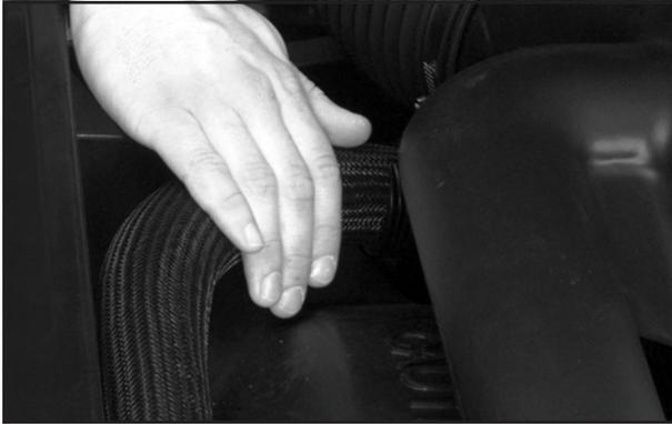
4. Sans remettre le bouchon de pression du réservoir d'expansion, mettre le moteur en marche et le laisser tourner jusqu'à ce que vous sentiez que la durite supérieure de radiateur commence à chauffer. Faire attention au ventilateur de refroidissement du moteur.
