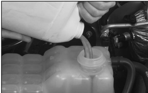
3. Remplir ensuite le réservoir d'expansion avec le mélange approprié jusqu'au repère FULL COLD (plein à froid).
