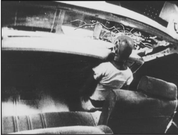
Ce passager poursuivra sa course jusqu'à ce qu'il soit arrêté par quelque chose. Dans un vrai véhicule, cela pourrait être le pare-brise...
