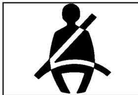
Ce carillon et ce témoin fonctionneront de nouveau si le conducteur ne boucle pas sa ceinture de sécurité et que le véhicule se déplace.
