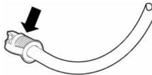
3. En utilisant l'outil à bouchon jaune, appuyez sur la languette qui se trouve sur le boîtier du compresseur de la trousse de gonflage de secours tout en tirant sur le contenant de produit d'obturation.
