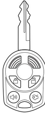
La fonction de verrouillage ou de déverrouillage de la télécommande fonctionne dans toutes les positions du commutateur d'allumage, sauf lorsque la clé est maintenue à la position START (démarrage). La fonction d'alarme de détresse est disponible lorsque le commutateur d'allumage est à la position OFF (arrêt).
