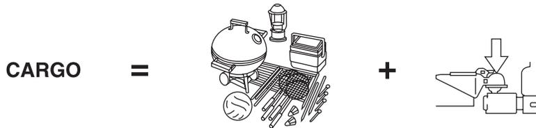
**Poids de la charge** – Cela comprend le poids ajouté au poids en ordre de marche, y compris la charge et les équipements en option. Si vous tirez une remorque, le poids du timon de la remorque ou du pivot d'attelage fait également partie du poids de la charge.
