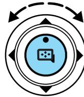
2. Déplacez la commande pour orienter le rétroviseur à la position voulue.
