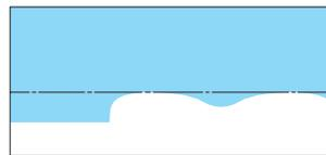
Si la bordure de cette bande lumineuse n'est pas au même niveau que la ligne de repère horizontale, les phares doivent être réglés.
