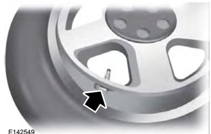
**Note :** Les quatre roues du véhicule sont munies d'un capteur de pression de pneu situé à l'intérieur de la jante. Le capteur de pression est fixé au corps de valve. Le capteur de pression est masqué par le pneu et n'est pas visible à moins d'enlever le pneu. Veillez à ne pas endommager le capteur lors du remplacement d'un pneu.
