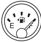
La flèche à côté du symbole de distributeur d'essence indique le côté du véhicule où est situé l'orifice de remplissage du réservoir de carburant.
