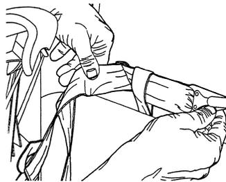
2. Acheminez la sangle de retenue derrière les supports de l'appui-tête, puis vers une boucle se trouvant derrière une place adjacente et fixez le crochet de la sangle dans la boucle. Du côté passager, acheminez la sangle derrière la fixation du baudrier du siège central.
