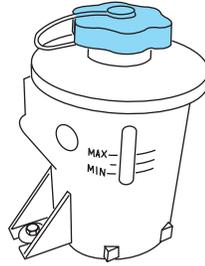
5. Si le niveau du liquide est insuffisant, ajoutez du liquide par petites quantités, en vérifiant le niveau à chaque fois, jusqu'à ce qu'il se trouve entre les repères MIN et MAX. N'oubliez pas de remettre le bouchon sur le réservoir.
