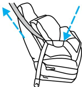
8. Laissez la ceinture de sécurité se rétracter pour la tendre.
