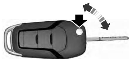
Appuyez sur le bouton pour libérer le panneton. Maintenez le bouton enfoncé pour replier le panneton lorsqu'il n'est pas utilisé.
