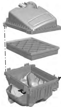
7. Installez un élément filtrant neuf. Prenez soin de ne pas coincer les rebords de l'élément filtrant entre le boîtier et le couvercle du filtre à air. Cela pourrait endommager le filtre et permettre l'entrée d'air non filtré dans le moteur si le filtre n'était pas bien en place.
