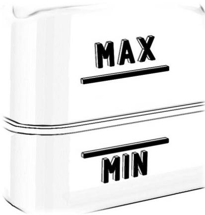
Pour éviter toute contamination du liquide, le bouchon du réservoir doit rester en place et serré à moins que vous n'ajoutiez du liquide.
