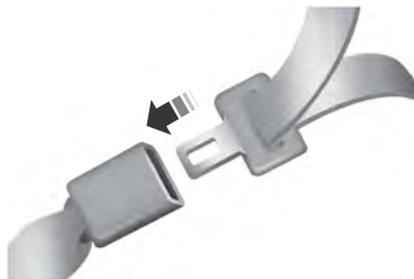
1. Pour boucler la ceinture, insérez la languette dans la boucle correspondante (la plus proche de la direction d'où provient la languette) jusqu'à ce qu'elle s'enclenche et que vous entendiez un déclic. Assurez-vous que la languette est bloquée dans la boucle.
