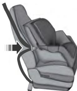
3. Tout en tenant à la fois le baudrier et la ceinture sous-abdominale, faites passer la languette à travers le dispositif de retenue pour enfant selon les directives du fabricant du dispositif. Assurez-vous de ne pas vriller la sangle.
