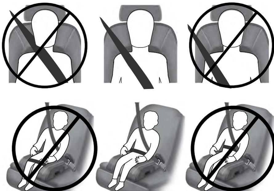
Si le rehausseur glisse sur le siège du véhicule où il est utilisé, il peut être maintenu en place en installant un filet caoutchouté vendu comme doublure d'étagère ou sous-tapis. Ne placez aucun objet d'épaisseur supérieure à ces articles sous le rehausseur. Consultez les directives du fabricant du rehausseur.
