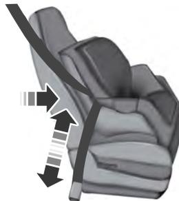
10. Avant d'asseoir l'enfant, essayez de déplacer le siège d'avant en arrière pour vérifier qu'il est bien fixé. Pour ce faire, empoignez le siège au niveau du passage de la sangle et tentez de le déplacer latéralement, puis de l'avant vers l'arrière. Si le siège est bien installé, il ne sera pas possible de le faire bouger de plus de 2,5 cm (1 po).
