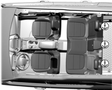
Suivez les étapes suivantes pour fixer un dispositif de retenue pour enfant au moyen des points d'ancrage du véhicule :
