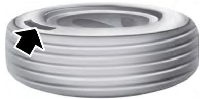
Les indices de qualité des pneus concernent les pneus neufs dédiés aux voitures de tourisme. L'indice de qualité se trouve, le cas échéant, sur le flanc du pneu, entre l'épaulement et la largeur de section maximale. Par exemple : **Indicateur d'usure 200 Adhérence AA Température A.**
