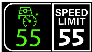
La vitesse programmée et la limite de vitesse détectée apparaissent entre parenthèses à l'écran d'information.
