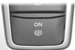
Appuyez sur le bouton de la console pour accéder à la fonction de retenue automatique sur l'écran tactile.
