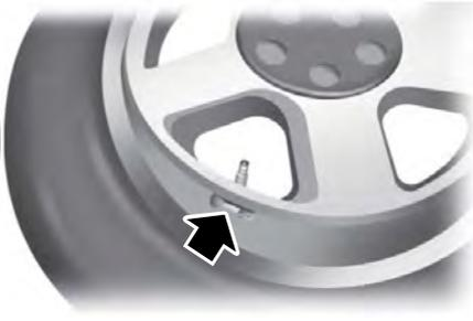
**Nota:** Chaque pneu est muni d'un capteur de pression des pneus situé dans la cavité de la roue. Le capteur de pression est fixé au corps de valve. Le capteur de pression est couvert par le pneu et n'est pas visible, à moins d'enlever le pneu. Veillez à ne pas endommager le capteur lors du remplacement d'un pneu.
