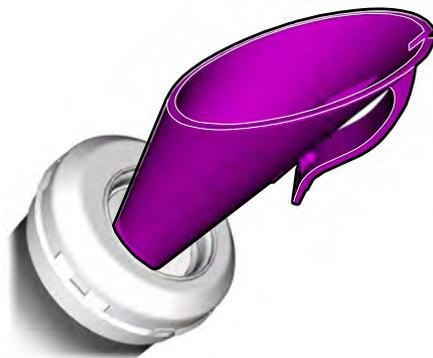
Utilisez l'entonnoir de remplissage fourni avec votre véhicule si vous devez remplir le réservoir de carburant au moyen d'un bidon de carburant. Voir **Emplacement de l'entonnoir de remplissage de réservoir de carburant** (page 183).
