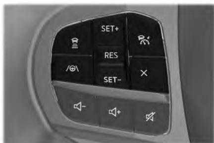
Voir **Activation et désactivation du régulateur de vitesse adaptatif** (page 234). Voir **Réglage de la vitesse du régulateur de vitesse adaptatif** (page 234). Voir **Réglage de la distance de suivi du régulateur de vitesse adaptatif** (page 235).
