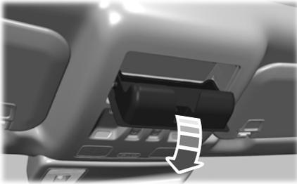
Le porte-lunettes est situé dans la console au pavillon. Appuyez sur le bord arrière du compartiment pour l'ouvrir.
