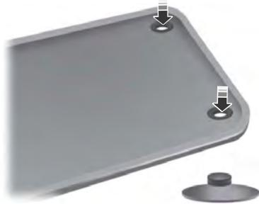
Pour poser les tapis qui sont dotés d'œillets, placez un œillet du tapis par-dessus la tige de fixation et appuyez pour le bloquer en place. Répétez l'opération pour tous les œillets du tapis.
