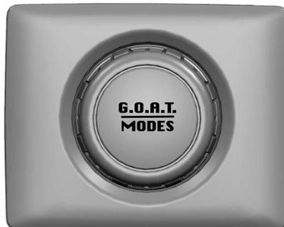
Utilisez la commande **G.O.A.T. MODES** sur la console pour sélectionner un mode de conduite.
