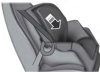
5. Pour placer l'enrouleur en mode de blocage automatique, tirez sur le baudrier vers le bas jusqu'à dérouler entièrement la sangle.
