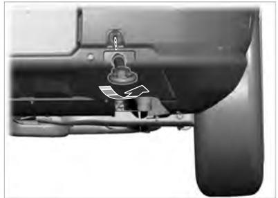
1. Retirez soigneusement le cache du point d'attache de l'œillet de remorquage avant ou arrière.
