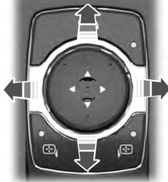
Appuyez sur les flèches pour régler le rétroviseur.
