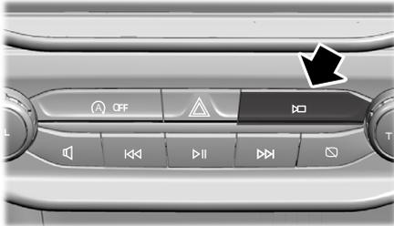
Grâce au bouton du système de caméra situé sur la chaîne audio, vous pouvez activer et désactiver la caméra avant.
