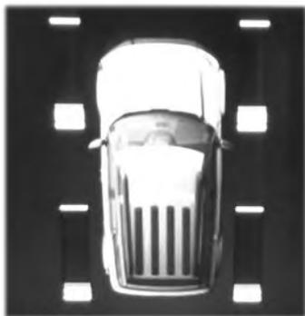
Une image à l'écran d'information signale la distribution de la puissance entre les roues avant et arrière. Plus la zone est remplie, plus la puissance est dirigée vers la roue en question.
