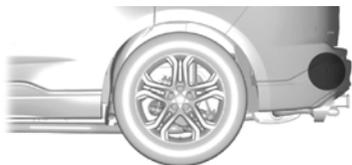
Les capteurs se trouvent derrière le pare-chocs arrière sur les deux côtés du véhicule.
