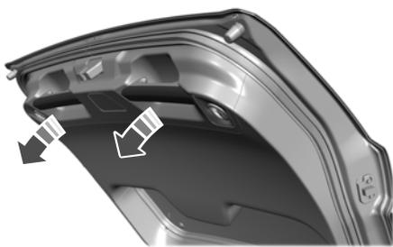
Utilisez les poignées à l'intérieur du hayon pour faciliter sa fermeture.
