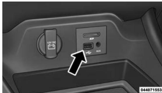
Cette caractéristique permet de brancher un iPod<sup>MD</sup> ou un dispositif USB externe sur le port USB.
