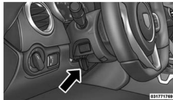
Levier d'inclinaison de la colonne de direction
