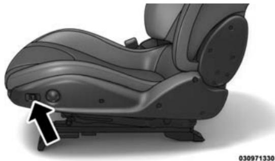
Commutateur d'inclinaison du dossier de siège à réglage électrique
