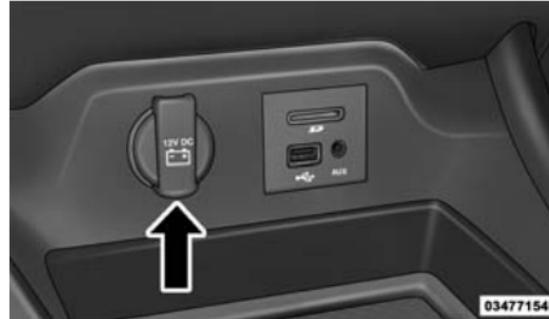
**NOTA :** Ne dépassez pas la puissance maximale de 160 W (13 A) à 12 V. Si la valeur nominale de 160 W (13 A) de la puissance est dépassée, le fusible protégeant le système devra être remplacé.
