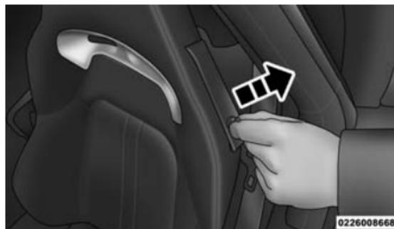
Dégagement vers le haut du dispositif de retenue de la boucle du guide de la ceinture de sécurité
