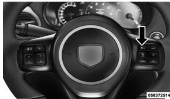
Bouton ESC (Commande de stabilité électronique)
