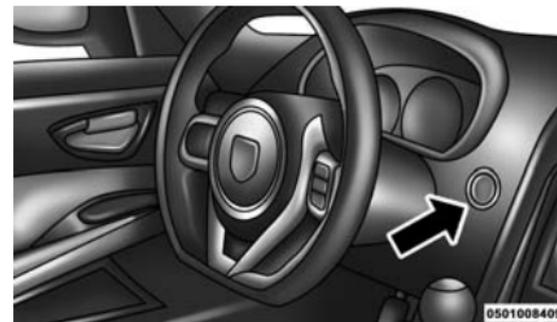
**Bouton ENGINE START/STOP (DÉMARRAGE ET ARRÊT DU MOTEUR)**
