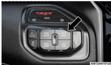
Bouton AXLE LOCK (VERROUILLAGE D'ESSIEU)
