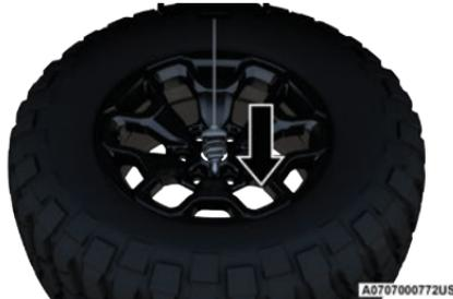
**Positionnement du dispositif de retenue par le centre de la roue**
