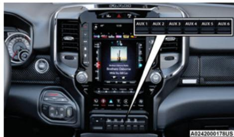
**Emplacement du commutateur auxiliaire**
