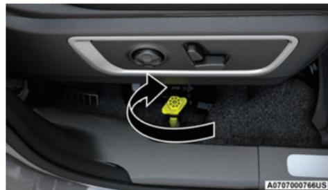
Boulon à oreilles du dispositif de retenue du cric
