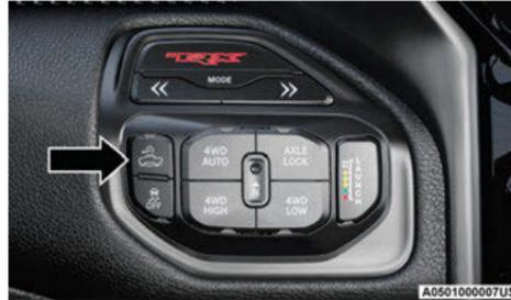
Commutateur du système de régulateur de vitesse de sélection
