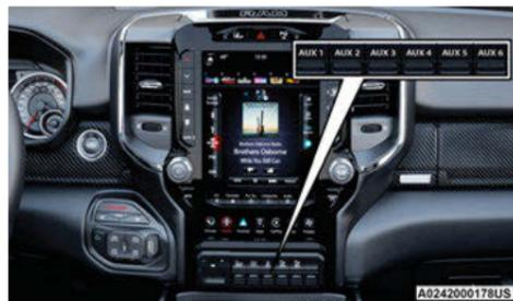
Emplacement du commutateur auxiliaire
