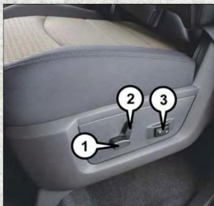
Commutateurs de siège à réglage électrique
