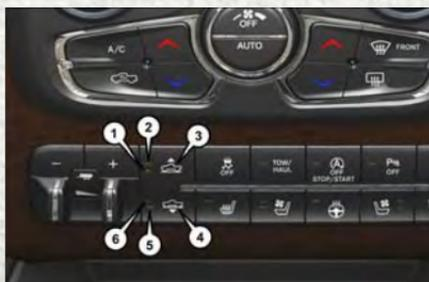
Commandes de suspension pneumatique du modèle 1500
