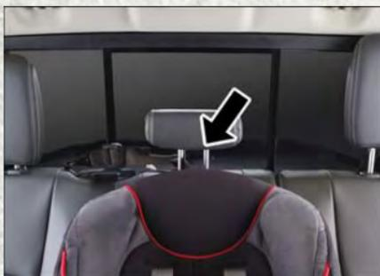
**Courroie d'attache par la boucle de courroie d'attache du siège central**
