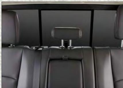
**Boucle de courroie d'attache avec appui-tête central en position relevée**
