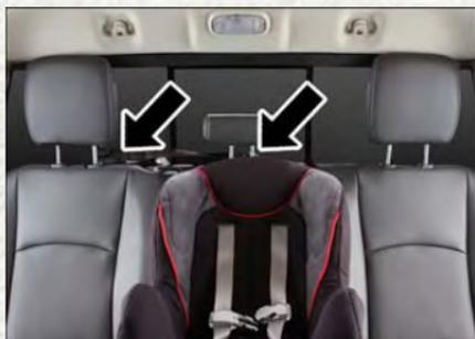
**Courroie d'attache par la boucle de courroie d'attache du siège central et fixée à la boucle de courroie d'attache du siège d'extrémité**
