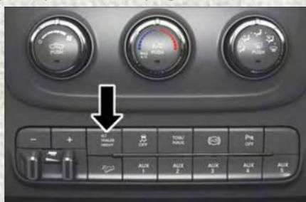
**Bouton « Alt Trailer Height » (Hauteur auxiliaire de la remorque)**
