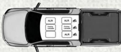
**Emplacements de l'enrouleur à blocage automatique (EBA) (cabine Quad Cab/cabine Mega/cabine double)**
