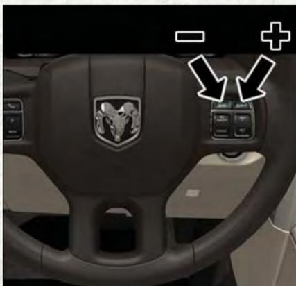
Commande du système de sélection électronique des rapports
