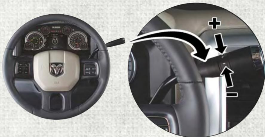
Commande du système de sélection électronique des rapports sur le sélecteur de vitesses
