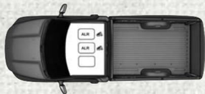
Emplacements de l'enrouleur à blocage automatique (EBA) (cabine simple)
