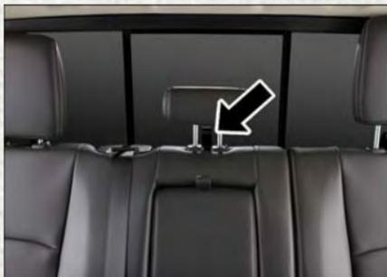
**Boucle de courroie d'attache avec appuie-tête en position relevée**
