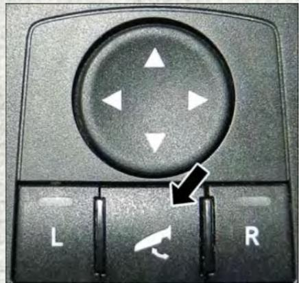
Commutateur des rétroviseurs rabattables à commande électrique
