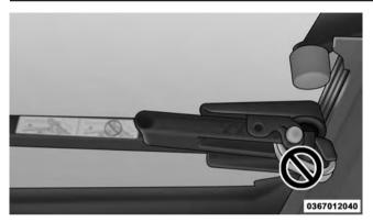
**Improper Clamp Position**
