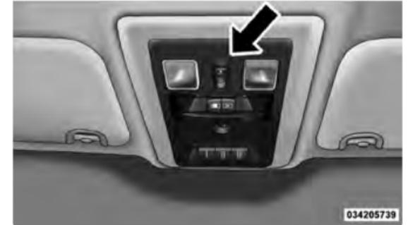
**Commutateur de toit ouvrant à commande électrique**
