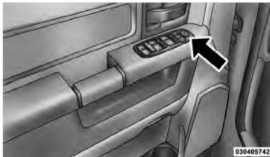
Commandes électriques des rétroviseurs
