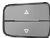
Bouton de commande du centre d'information électronique sur le volant s'affichant du côté gauche du volant de direction.
