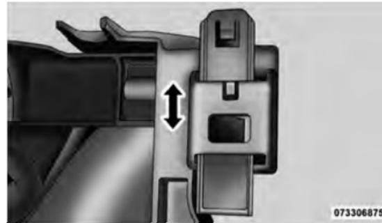
9. Retirez le bloc optique du phare. Saisissez le rebord extérieur du phare et tirez-le fermement vers l'avant pour dégager le pivot à rotule de l'oeillet en plastique.
