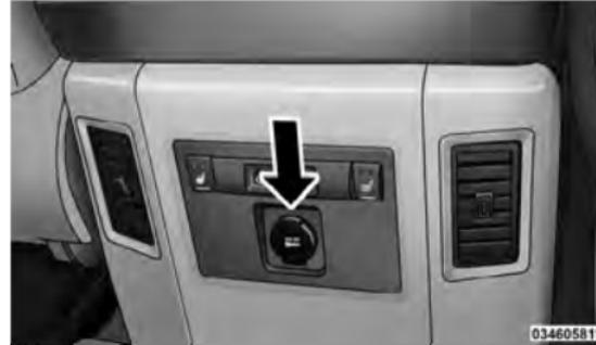
Prise de courant – arrière de la console centrale
