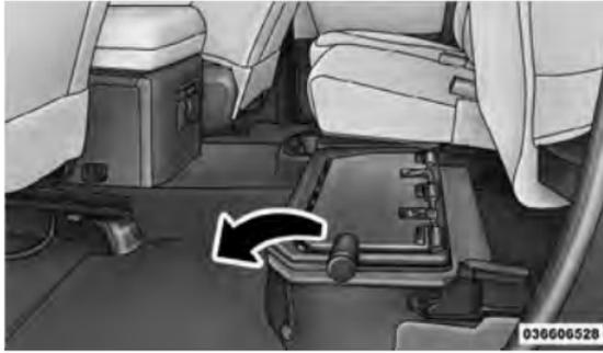
**Déploiement du plancher de chargement**
