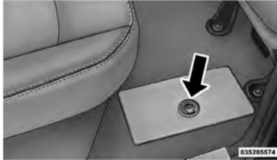
**Loquet du bac de rangement dissimulé dans le plancher**
