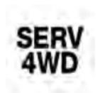
Ce témoin contrôle le système électrique de passage en mode quatre roues motrices. Si le témoin **SERV 4WD** (vérifier le système à quatre roues motrices) demeure allumé ou s'allume en cours de route, cela indique que le système à quatre roues motrices ne fonctionne pas correctement et qu'il doit être vérifié.
