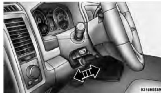
Levier de colonne de direction inclinable
