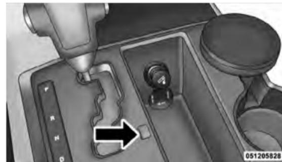
**Neutralisation manuelle du dispositif de déverrouillage**
