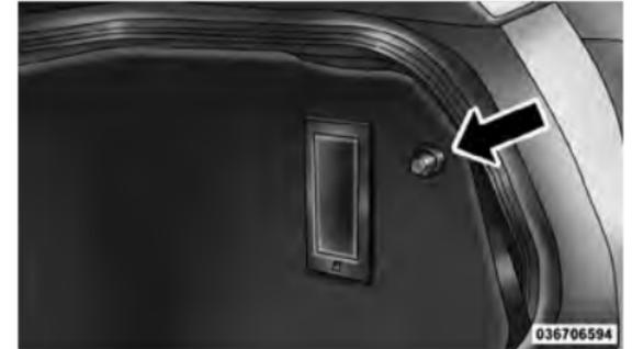
Commutateur d'éclairage du bac RamBox<sup>MC</sup>
