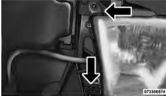
7. Passez votre main par le passage de roue avant, devant la roue, enlevez l'attache et levez le couvercle de l'orifice d'accès de la partie avant du bouclier de passage de roue. Vous pouvez accéder à l'arrière de l'ampoule par ce trou d'accès.
