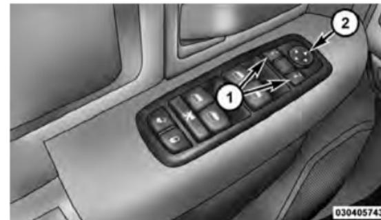
Commandes électriques des rétroviseurs
