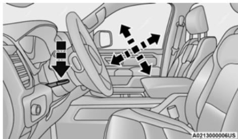
Levier d'inclinaison et de réglage télescopique
