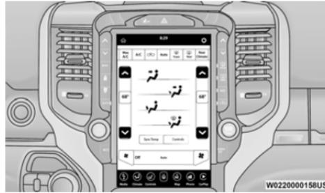
Commandes automatiques de température du système Uconnect 5 AVEC NAVIGATION avec écran de 12 pouces
