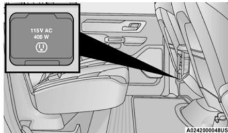
**Prise de l'onduleur d'alimentation de la console centrale arrière**
