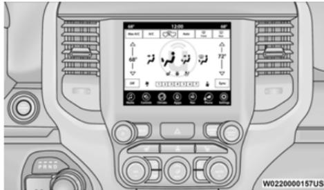
Commandes automatiques de température du système Uconnect 5 ou 5 AVEC NAVIGATION avec écran de 8,4 pouces
