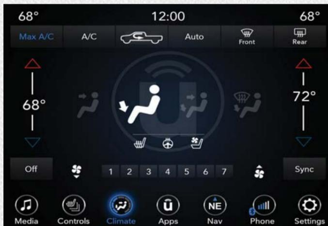
Commandes de chauffage-climatisation à réglage automatique du système Uconnect 4/4C/4C AVEC NAVIGATION avec affichage de 8,4 pouces
