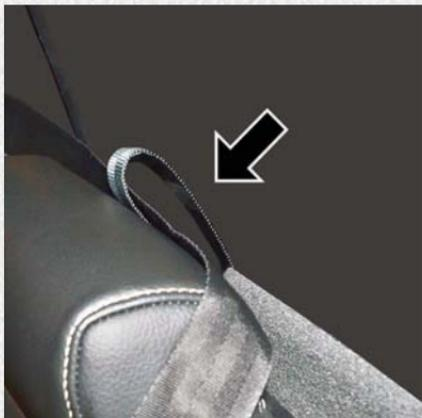
**Courroie d'attache par la boucle de courroie d'attache du siège central**
