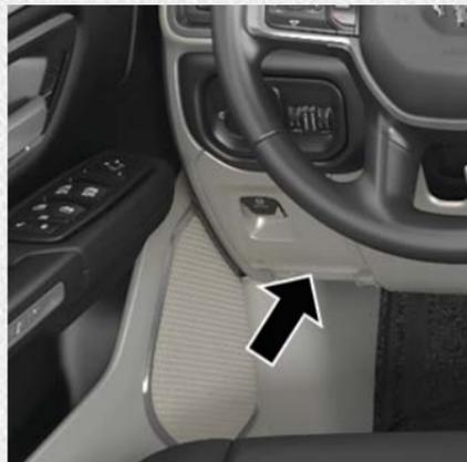
**Couvercle d'accès du levier de déverrouillage de position de stationnement manuel**
