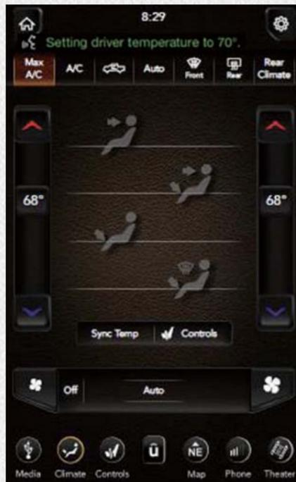
**Menu Chauffage-climatisation du système Uconnect 4C AVEC NAVIGATION avec affichage de 12 pouces**
