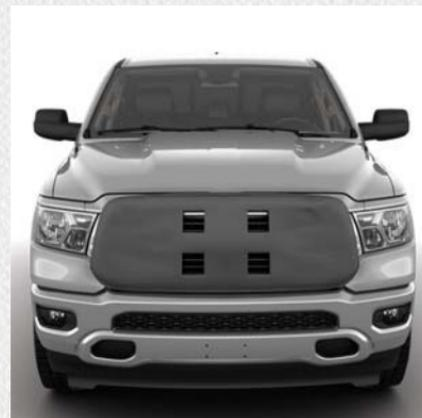
Un couvercle de protection avant contre le froid doit être utilisé lorsque la température ambiante est inférieure à 0 °C (32 °F), surtout durant des périodes de ralenti prolongé. Ce couvercle est équipé de quatre rabats pour gérer l'ouverture de la calandre entière sous des températures ambiantes variables. Si un couvercle de protection avant contre le froid est utilisé, les rabats doivent être en position
