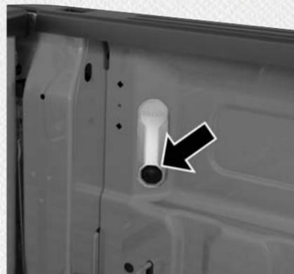
**Commutateur d'éclairage de caisse dans la caisse du camion**
