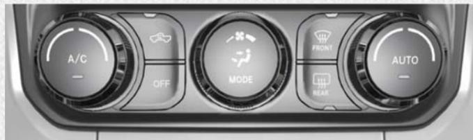
**Boutons des commandes de chauffage-climatisation à réglage automatique du système Uconnect 4C et 4C AVEC NAVIGATION avec affichage de 8,4 pouces**
