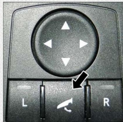
Commutateur des rétroviseurs rabattables à commande électrique
