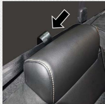
Ancrage d'attache central sur l'appuie-tête
