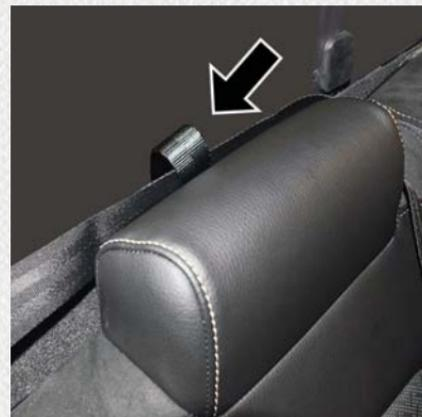
**Emplacement de la boucle de courroie d'attache du siège central**
