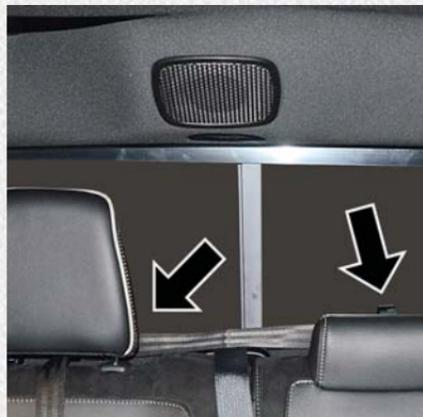
**Courroie d'attache par la boucle de courroie d'attache du siège d'extrémité et fixé à la boucle de courroie d'attache du siège central**
