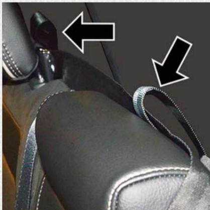
**Courroie d'attache par la boucle de courroie d'attache du siège central et fixée à la boucle de courroie d'attache du siège d'extrémité**
