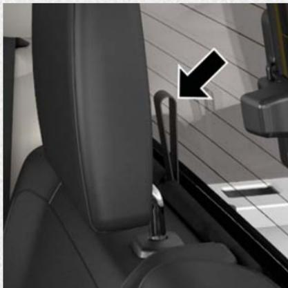
Ancrage d'attache du siège d'extrémité
