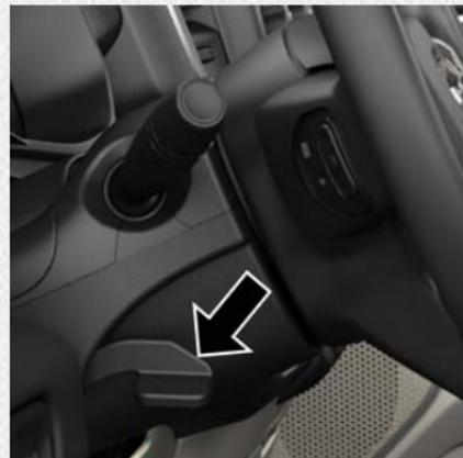
Levier d'inclinaison et de réglage télescopique
