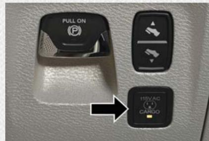
Commutateur de l'onduleur d'alimentation du tableau de bord
