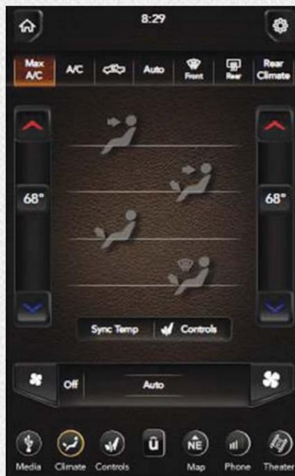
Commandes de chauffage-climatisation à réglage automatique du système Uconnect 4C AVEC NAVIGATION avec affichage de 12 pouces
