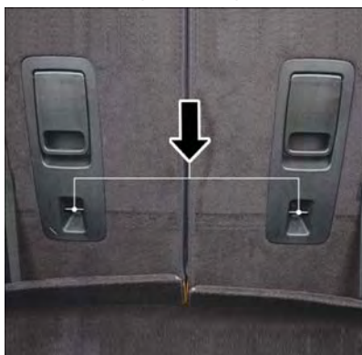
Troisième rangée d'ancrages d'attache
