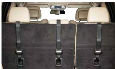
Montage de la courroie d'attache supérieure (siège 60/40)
