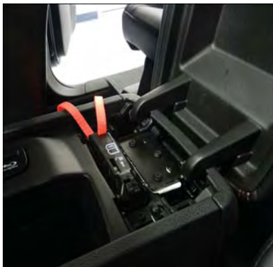
Retrait du couvercle du levier de déverrouillage de position de stationnement manuel
