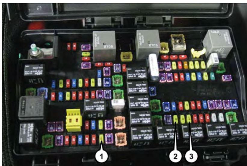
Emplacements des fusibles pour les prises de courant
