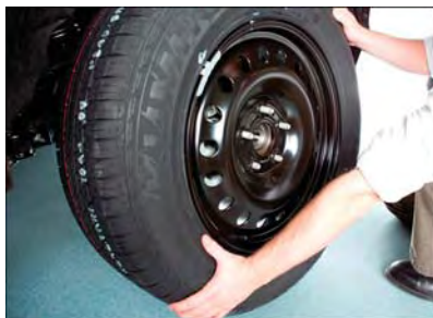
Montage de la roue de secours
