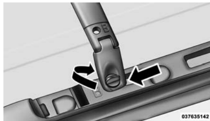
Installation des traverses
