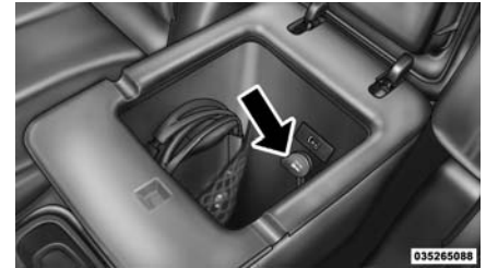
Prise de courant de la console à plein centre arrière
