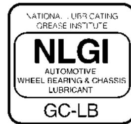
Il existe deux catégories de graisses : celles qui sont conçues pour le graissage des roulements de roue (lettre « G ») et celles qui sont
