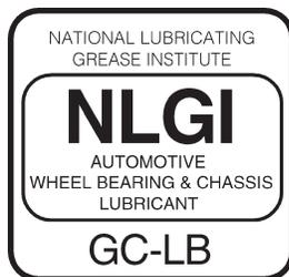
Deux catégories de graisses sont identifiées : celles destinées au graissage des roulements de roue (lettre « G ») et celles destinées
