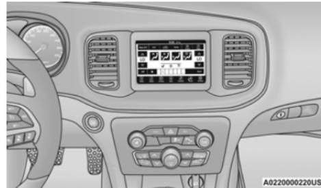
Menu des commandes automatiques du système de chauffage-climatisation du système Uconnect 4 avec affichage de 7 pouces
