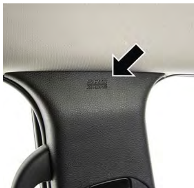
Emplacement de l'étiquette de rideaux gonflables latéraux complémentaires
