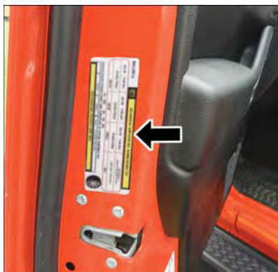
Exemple d'emplacement de l'étiquette des pneus (portière)
