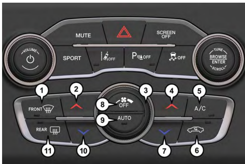
Commandes du système de chauffage-climatisation automatique
