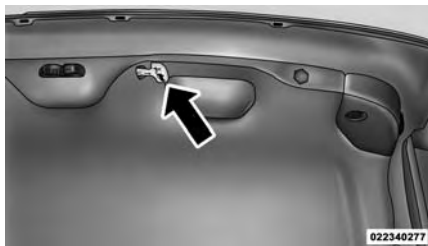
Dispositif interne de déverrouillage d'urgence du coffre
