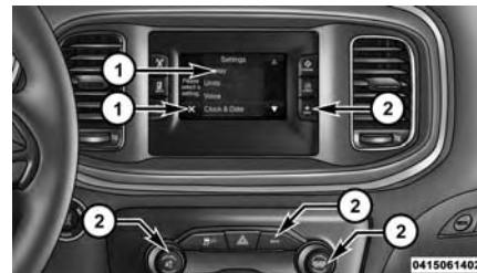
Boutons situés sur l'écran tactile et boutons situés sur la plaque frontale du système Uconnect 5.0
