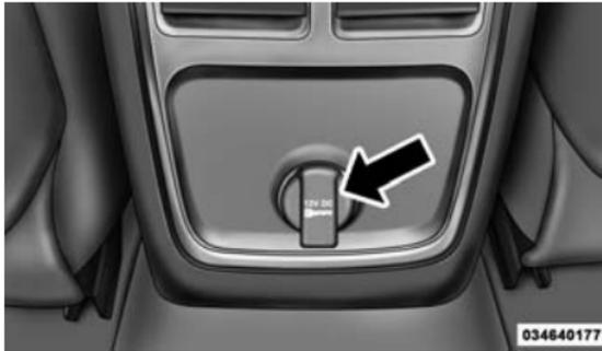
Prise de courant de la console centrale arrière
