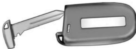
**Séparation du boîtier de télécommande de télédéverrouillage**
