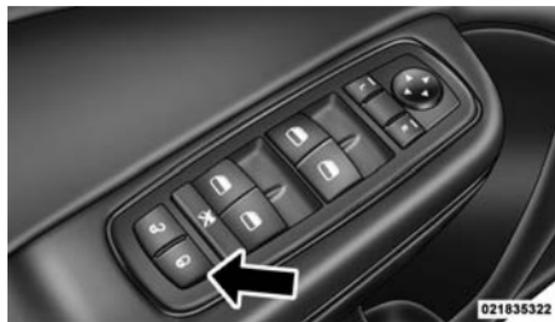
Commutateur de verrouillage électrique des portes
