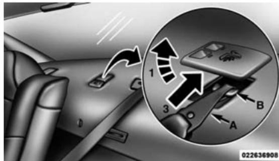
Montage de la courroie d'attache
