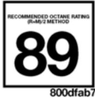
Ce moteur est conçu en conformité avec les règlements antipollution et offre une consommation et un rendement satisfaisants avec de l'essence sans plomb de qualité supérieure d'un indice d'octane de 87 à 89. Pour vous assurer d'un rendement optimal, le constructeur recommande l'utilisation d'une essence à indice d'octane de 89. Il n'est pas conseillé d'utiliser du supercarburant puisqu'il n'offre aucun avantage supplémentaire par rapport à l'essence ordinaire dans ce type de moteur.
