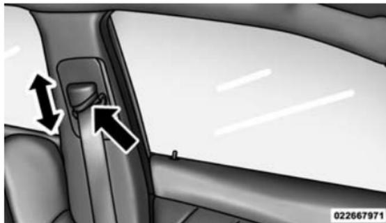
**Réglage de l'ancrage supérieur du baudrier**
