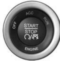
Cette fonction permet au conducteur d'actionner le commutateur d'allumage en enfonçant un bouton, pourvu que la télécommande du système de démarrage à distance ou du système d'accès et de démarrage sans clé Keyless Enter-N-Go<sup>MC</sup> se trouve dans l'habitacle.
