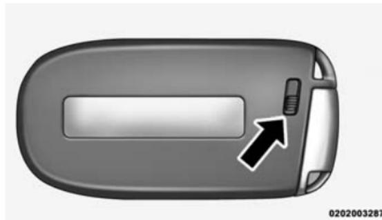
Loquet mécanique situé sur la partie arrière de la télécommande
