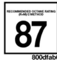
Ce moteur est conçu en conformité avec les règlements antipollution et offre une consommation et un rendement excellents avec de l'essence sans plomb ordinaire de haute qualité d'un indice d'octane de 87. Il n'est pas conseillé d'utiliser du supercarburant puisqu'il n'offre aucun avantage supplémentaire par rapport à l'essence ordinaire dans ce type de moteur.
