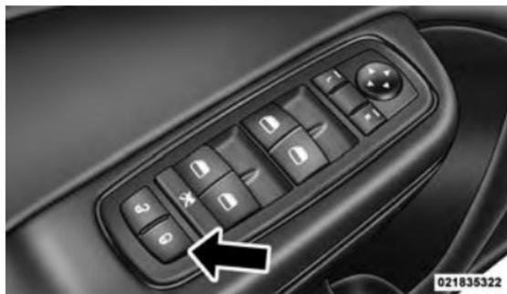
Commutateur de verrouillage électrique des portes
