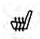
Appuyez une fois sur la touche Driver (conducteur) ou Pass (passager), située à l'écran du système Uconnect Touch<sup>MC</sup>, pour sélectionner le chauffage de niveau HI (élevé). Appuyez sur la touche une deuxième fois pour sélectionner le chauffage de niveau bas. Appuyez sur la touche une troisième fois pour éteindre le chauffage.
