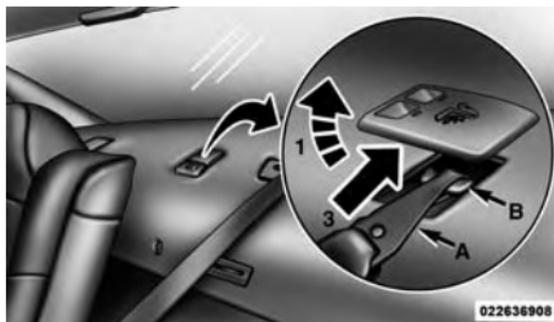
Montage de la courroie d'attache
