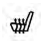
Appuyez une fois sur le commutateur pour sélectionner le chauffage de niveau « HI » (élevé). Appuyez une deuxième fois sur le commutateur pour sélectionner le chauffage de niveau « LO » (bas). Appuyez une troisième fois sur le commutateur pour mettre les éléments de chauffage hors fonction.
