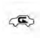
Lorsque l'air extérieur contient de la fumée, des odeurs, un taux d'humidité élevé, ou que vous souhaitez refroidir rapidement l'habitacle, vous pouvez recirculer l'air de l'habitacle en appuyant sur le bouton de commande de recirculation. Le témoin de mode de recirculation s'allume lorsque vous sélectionnez ce
