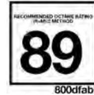
Ce moteur est conçu en conformité avec les règlements antipollution et offre une consommation et un rendement satisfaisants avec de l'essence sans plomb de qualité supérieure d'un indice d'octane de 87 à 89. Pour vous assurer d'un rendement optimal, le constructeur recommande l'utilisation d'une essence à indice d'octane de 89. Il n'est pas conseillé d'utiliser du supercarburant puisqu'il n'offre aucun avantage supplémentaire par rapport à l'essence ordinaire dans ce type de moteur.
