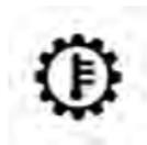
Ce témoin indique que la température du liquide de la transmission est élevée. Il peut s'allumer en conditions d'utilisation intense, comme lors de la traction d'une remorque. Si ce témoin s'allume, rangez le véhicule en toute sécurité et immobilisez-le. Placez ensuite le levier de vitesses de la transmission à la position N (point mort) et faites tourner le moteur au ralenti ou plus rapidement jusqu'à ce que le témoin s'éteigne.
