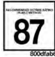
Ce moteur est conçu en conformité avec les règlements antipollution et offre une consommation et un rendement excellents avec de l'essence sans plomb ordinaire de haute qualité d'un indice d'octane de 87. Il n'est pas conseillé d'utiliser du supercarburant puisqu'il n'offre aucun avantage supplémentaire par rapport à l'essence ordinaire dans ce type de moteur.
