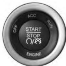
Cette fonction permet au conducteur d'actionner le commutateur d'allumage en enfonçant un bouton, pourvu que la télécommande de télédéverrouillage/accès et démarrage sans clé Enter-N-Go<sup>MC</sup> se trouve dans l'habitacle.
