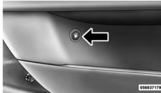
Commutateur de déverrouillage de trappe de carburant
