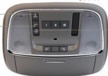
Les commutateurs de toit ouvrant à commande électrique se trouvent sur la console au pavillon.
