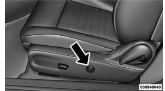
Commande de support lombaire à réglage électrique
