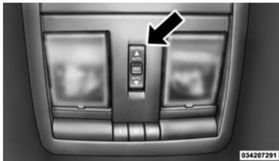
Commutateur de toit ouvrant à commande électrique
