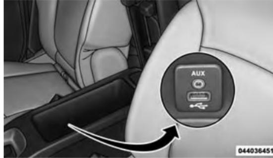
**Port de connecteur USB ou AUX (auxiliaire) de la console centrale**
