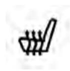
Appuyez une fois sur le commutateur pour sélectionner le chauffage de niveau ÉLEVÉ. Appuyez une deuxième fois sur le commutateur pour sélectionner le chauffage de niveau BAS. Appuyez une troisième fois sur le commutateur pour mettre les éléments de chauffage hors fonction.
