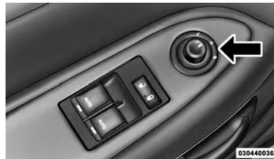
Commande des rétroviseurs électriques
