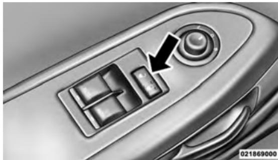
**Commutateur de verrouillage électrique des portes**
