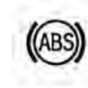
Ce témoin surveille le fonctionnement du système de freinage antiblocage. Il s'allume lorsque le commutateur d'allumage est mis à la position ON/RUN (marche) et peut demeurer allumé pendant quatre secondes.
