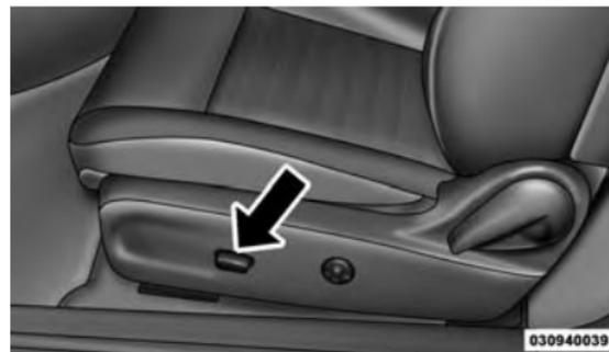
Commutateur de siège à commande électrique
