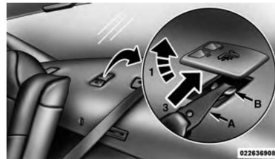
Montage de la courroie d'attache
