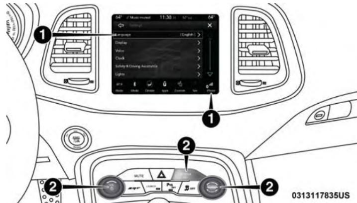
Boutons situés sur l'écran tactile et boutons situés sur la plaque frontale des systèmes Uconnect 4C et 4C AVEC NAVIGATION
