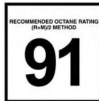
Ces moteurs sont conçus en conformité avec tous les règlements antipollution et offre une économie de carburant et un rendement excellents avec du supercarburant sans plomb de qualité supérieure d'un indice d'octane de 91 tel qu'indiqué par la méthode (R+M)/2. L'utilisation du supercarburant d'un indice d'octane de 91 ou plus
