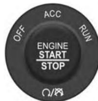
Cette fonction permet au conducteur d'actionner le commutateur d'allumage en enfonçant un bouton, pourvu que le bouton ENGINE START/STOP (DÉMARRAGE ET ARRÊT DU MOTEUR) soit en place et que la télécommande du système de démarrage à distance ou du système d'accès et de démarrage sans clé Keyless Enter-N-Go se trouve dans l'habitacle.
