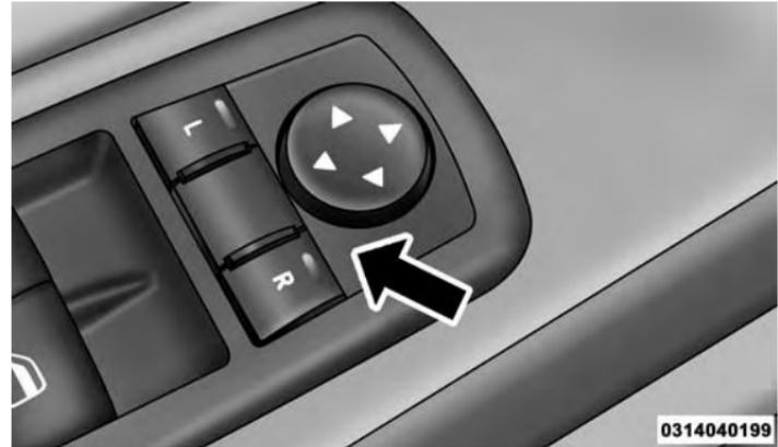
Commandes des rétroviseurs électriques
