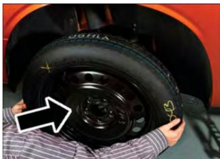
**Installation de la roue de secours compacte**
