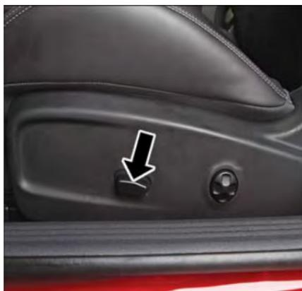
Commutateur de siège à commande électrique
