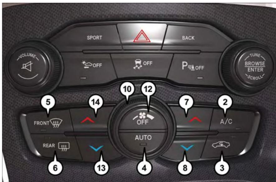
**Boutons du système de chauffage-climatation automatique**
