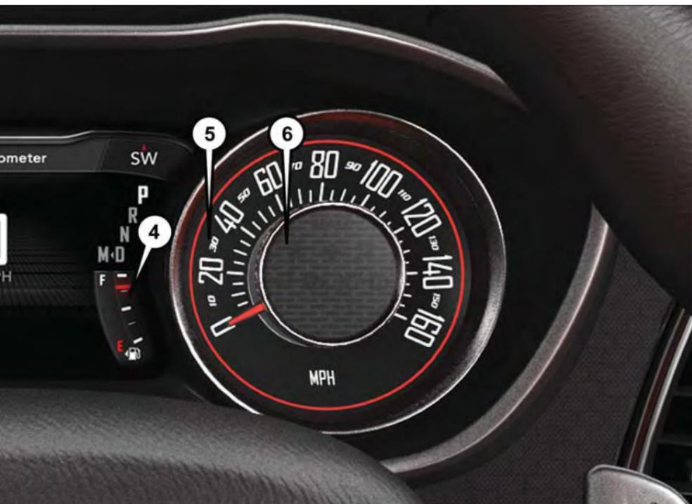
4. Emplacement de l'indicateur de niveau de carburant et de la trappe de carburant
