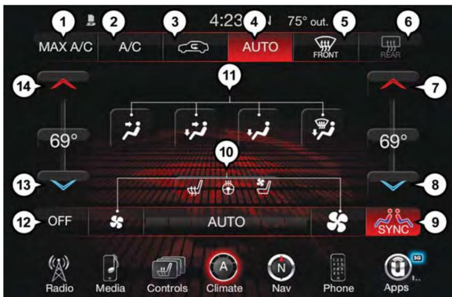
Système de chauffage-climatisation automatiques avec écran tactile du système Uconnect<sup>MD</sup> 8.4
