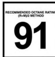
Ce moteur est conçu en conformité avec tous les règlements antipollution et offre une économie de carburant et un rendement excellents avec du supercarburant sans plomb de qualité supérieure d'un indice d'octane de 91 tel qu'indiqué par la méthode (R+M)/2. L'utilisation du supercarburant d'un indice d'octane de 91 ou plus est nécessaire pour ce moteur.
