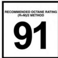
Ce moteur est conçu en conformité avec tous les règlements antipollution et offre une économie de carburant et un rendement excellents avec du supercarburant sans plomb de qualité supérieure d'un indice d'octane de 91 tel qu'indiqué par la méthode (R+M)/2. L'utilisation du supercarburant d'un indice d'octane de 91 ou plus est nécessaire pour ce moteur.
