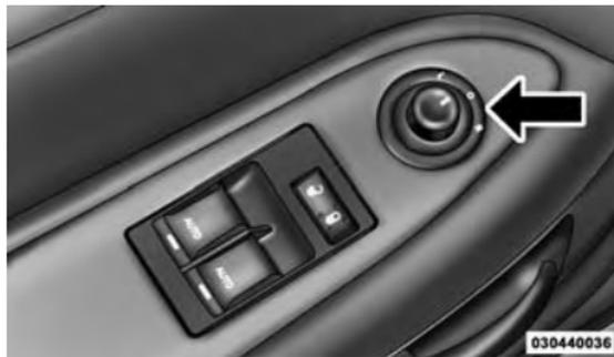
Commande des rétroviseurs électriques
