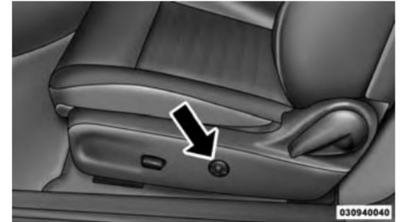
**Commande de support lombaire à réglage électrique**
