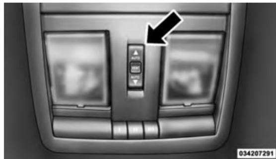
Commutateur de toit ouvrant à commande électrique
