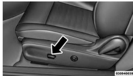
Commutateur de siège à commande électrique
