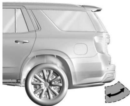
Pour l'actionner, déplacer le pied dans un mouvement de coup de pied vers l'avant sous le centre du pare-chocs arrière, puis retirer le pied.
