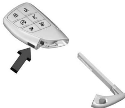
1. Appuyer sur le bouton situé sur le côté de la télécommande et extraire la clé mécanique. Ne jamais retirer la clé mécanique sans appuyer sur le bouton.
