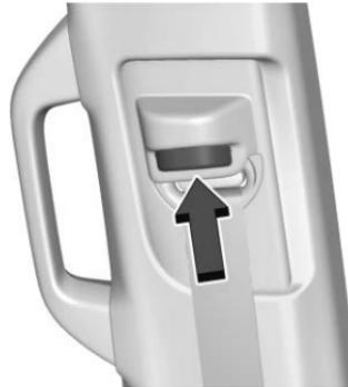
Pousser le bouton de déverrouillage pour déplacer le dispositif de réglage de hauteur à la position souhaitée.
