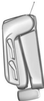
3. Tirer à nouveau sur la sangle pour libérer du plancher l'arrière du siège. Le siège se rabattra vers l'avant.
