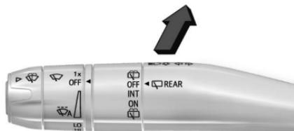
Selon l'équipement, appuyer sur le levier d'essuie-glace avant vers l'avant pour vaporiser du liquide lave-glace sur la lentille de la caméra arrière. Le levier retourne à la position de départ quand il est relâché. Consulter *Miroir de la caméra arrière* ⇨ 34.
