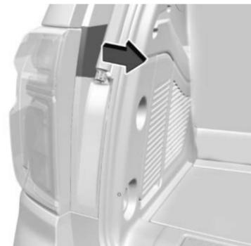
2. Déposer la pièce de garniture du milieu en tirant vers le centre du véhicule pour désengager les clips.
