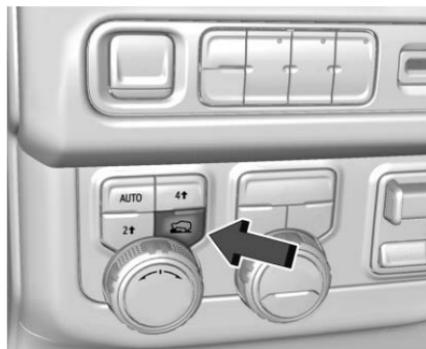
Pour activer le mode Terrain, appuyer sur le bouton de mode Terrain, à côté du bouton de mode.
