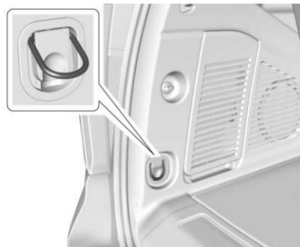
L'espace de chargement arrière est doté de deux ceillots d'arrimage de chargement. Ceux-ci peuvent être utilisés pour attacher le chargement et l'empêcher de se déplacer à l'intérieur du véhicule.
