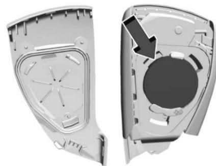
3. Soulever la pile au moyen d'un objet plat.
