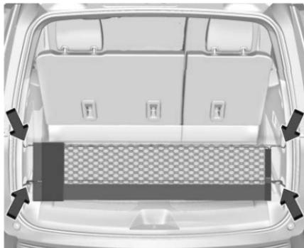
Un filet d'arrimage en option à l'arrière du véhicule permet d'immobiliser les petites charges une fois accroché aux points d'arrimage.
