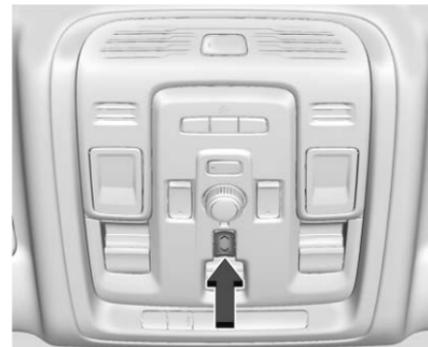
Appuyer et maintenir enfoncé
