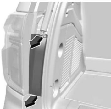
3. Retirer le couvercle de fermeture du feu arrière inférieur de l'ensemble de feu arrière en tirant vers l'arrière par le haut et le bas pour désengager les clips.
