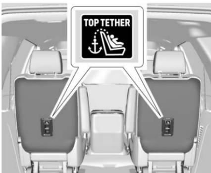
Pour les modèles avec sièges baquets de deuxième rangée, les points d'ancrage supérieurs se trouvent à l'arrière du dossier de siège, à chaque place assise de deuxième rangée. S'assurer d'utiliser un ancrage situé directement derrière la position d'assise où le siège pour enfant sera placé.
