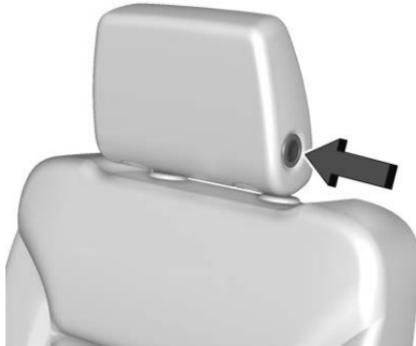
Pour rabattre l'appui-tête, appuyer sur le bouton situé sur le côté de l'appui-tête.
