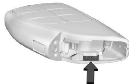
2. Lorsque la clé mécanique est retirée, introduire un objet plat et mince au centre de la clé télécommande pour les séparer et déposer le couvercle arrière.
