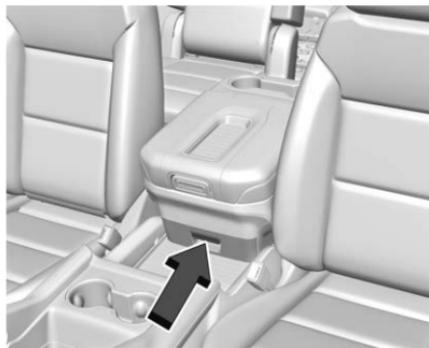
Lorsque la console centrale est complètement reculée, un bac de rangement se trouve sous l'accoudoir. Tirer sur la poignée pour l'ouvrir.
