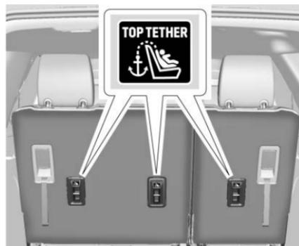
Pour les sièges de troisième rangée, les points d'ancrage supérieurs se trouvent sur l'arrière du dossier de siège. Utiliser un ancrage situé directement derrière la position d'assise où le siège pour enfant est placé.
