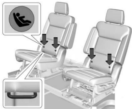
Les ancrages inférieurs sont situés dans la nervure médiane de capot, entre le dossier du siège et le coussin du siège.
