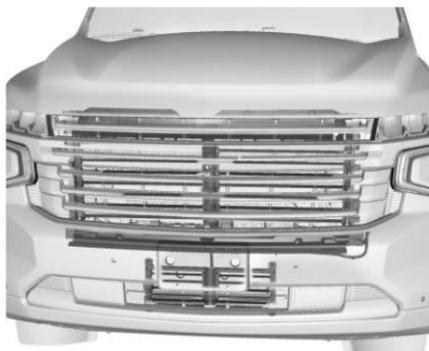
Le véhicule peut être équipé d'un système d'obturation conçu pour aider à améliorer l'économie de carburant. Garder le système d'obturation à l'écart des débris, de la neige et de la glace. Si le témoin de contrôle du moteur s'allume, vérifier si le système d'obturation est exempt de débris, de neige ou de glace.
