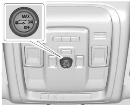
Selon l'équipement, le commutateur de hayon électrique est sur la console de plafond. Le véhicule doit être en position de stationnement (P).
