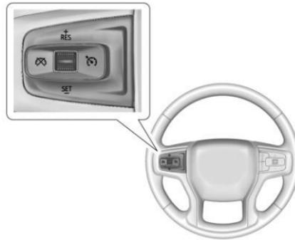
⇨ : Appuyer pour activer ou désactiver le régulateur automatique de vitesse. Un témoin blanc s'allume ou s'éteint sur le groupe d'instruments.
