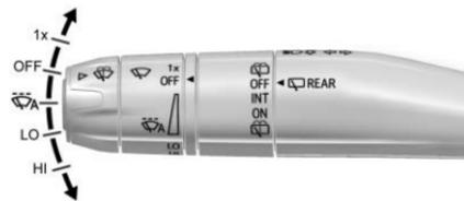
Le commutateur d'allumage étant positionné sur ON (marche) ou ACC/ACCESSORY (accessoires), déplacer le levier d'essuie-glace pour sélectionner la vitesse d'essuie-glace.
