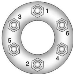
12. Serrer les écrous fermement en croix comme illustré en tournant la clé de roue dans le sens des aiguilles d'une montre.
