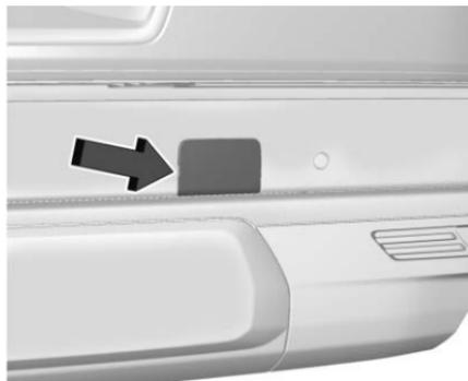
1. Ouvrir le couvercle d'accès à l'arbre du treuil (3) sur le pare-chocs pour accéder au verrou de la roue de secours (6).
