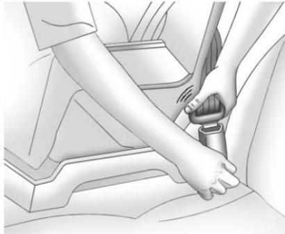
4. Enfoncer la plaque de blocage dans la boucle jusqu'à ce que vous entendiez un dé clic. Positionner le bouton de déblocage de la boucle, à l'écart du siège pour enfants, de manière à pouvoir détacher rapidement la ceinture de sécurité en cas de besoin.
