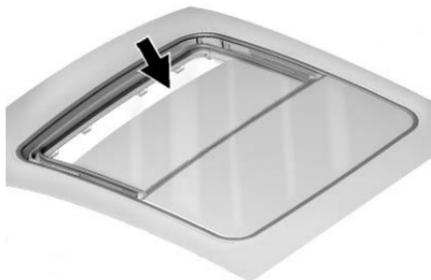
Des saletés et débris peuvent s'accumuler sur le joint d'étanchéité ou dans les glissières et peuvent causer un problème de fonctionnement du toit ouvrant, du bruit ou l'obturation du système d'évacuation d'eau. Ouvrir le toit ouvrant périodiquement et enlever tout obstacle ou débris. Essuyer le joint et les surfaces d'étanchéité du toit ouvrant à l'aide d'un chiffon propre, de savon doux et d'eau. Ne pas enlever la graisse du toit ouvrant.
