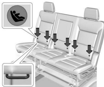
Les ancres inférieurs sont situés dans la nervure médiane de capot, entre le dossier du siège et le coussin du siège.
