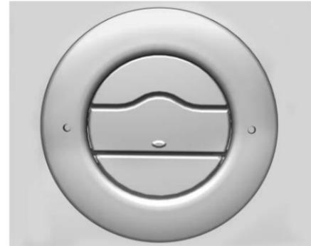
Appuyer sur le bord arrière de l'aube centrale pour ouvrir la bouche d'air ronde. Utiliser l'aube centrale pour faire tourner la bouche d'air et changer la direction du flux d'air. Appuyer sur le bord d'attaque de l'aube centrale pour couper le flux d'air.
