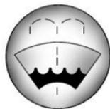
Enlever le bouchon marqué du symbole de lave-glace. Ajouter du liquide jusqu'à ce que le réservoir soit plein. Se reporter à *Aperçu du compartiment moteur* ⇨ 360 pour connaître l'emplacement du réservoir.
