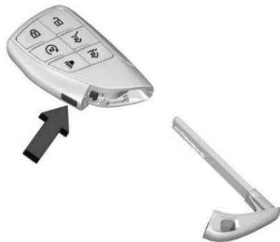
La clé mécanique à l'intérieur de la clé télécommande est utilisée pour la porte du conducteur et la boîte à gants.
