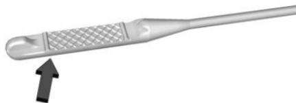
Si le niveau d'huile se situe au-dessous de la section quadrillée de la pointe de la jauge et que le moteur est éteint depuis au moins 15 minutes, ajouter 1 litre d'huile (1 pt) préconisée et vérifier encore le niveau. Se reporter à « Choix de l'huile moteur appropriée » plus loin dans cette section pour obtenir des explications sur le type d'huile à utiliser. Pour la capacité d'huile moteur du carter, se reporter à *Capacités et spécifications* ⇨ 458.
