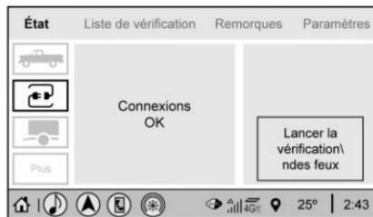
1. Bouton de démarrage de l'essai d'éclairage
