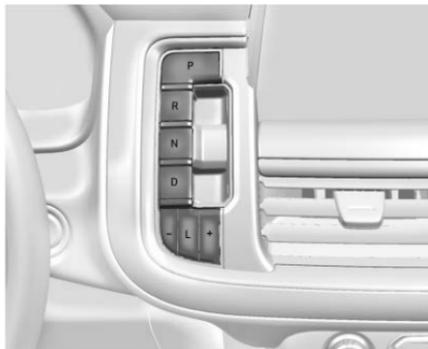
Les commutateurs de changement de vitesses sont sur la colonne centrale. La position du rapport sélectionné s'éclaire en rouge sur le commutateur de changement de vitesse, tandis que les autres rapports restent éclairés en blanc. Si le changement de rapport ne s'effectue pas immédiatement, par temps très froid par exemple, le témoin lumineux du commutateur de changement de vitesse peut clignoter jusqu'à ce que le rapport soit complètement engagé.
