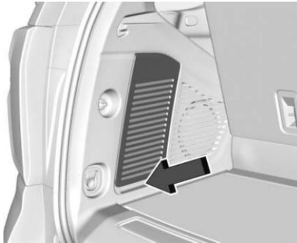
Le boîtier à fusibles de coffre se trouve derrière le panneau d'accès, du côté gauche du compartiment.
