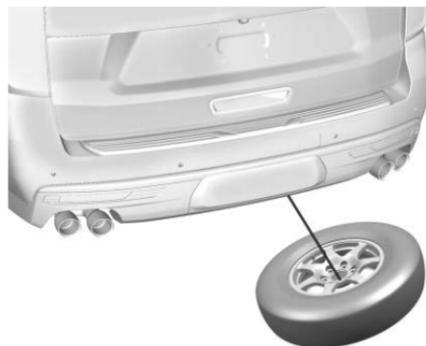
7. Pencher le pneu vers le véhicule avec un relâchement dans le câble afin d'accéder à la retenue de pneu/roue.
