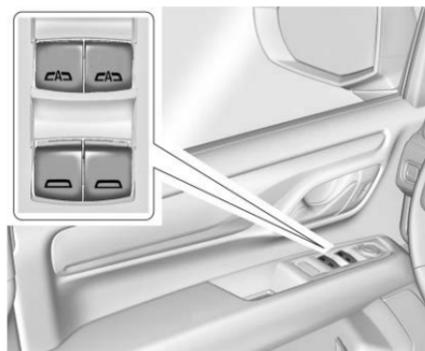
Les lève-vitres électriques fonctionnent lorsque le contact est mis, en position ACC/ACCESSORY (accessoires) ou lorsque la prolongation de l'alimentation des accessoires (RAP) est active. Se reporter à *Prolongation d'alimentation des accessoires* ⇨ 263.
