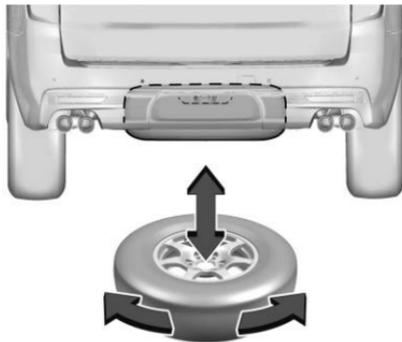
7. S'assurer de ranger le pneu en toute sécurité. Pousser, tirer et ensuite essayer de tourner le pneu. Si le pneu bouge, utiliser la clé de roue pour serrer le câble.
