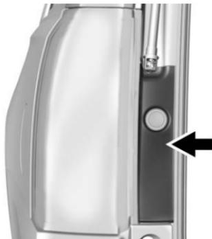
2. Retirer le couvercle de fermeture de feu arrière de l'ensemble de lampe en tirant vers l'arrière depuis le haut et le bas simultanément pour défaire les onglets qui se déboîtent.
