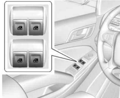
Les lève-vitres électriques fonctionnent lorsque le contact est mis, en position ACC/ACCESSORY (accessoires) ou lorsque la prolongation de l'alimentation des accessoires (RAP) est active. Se reporter à *Prolongation d'alimentation des accessoires* ⇨ 242.
