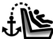
Pour localiser les ancrages d'attache supérieure, le symbole d'ancrage d'attache supérieure se trouve près des ancrages d'attache supérieure des sièges de deuxième rangée. Pour les sièges de troisième rangée (option), le symbole d'ancrage d'attache supérieure se trouve sur le panneau basculant.
