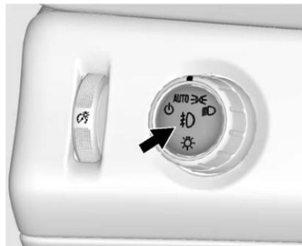
Si équipé de phares antibrouillard, le bouton se trouve sur la commande d'éclairage extérieur, à gauche de la colonne de direction.
