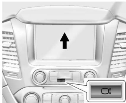
Si l'équipement comprend un compartiment de rangement derrière la radio, presser et maintenir
