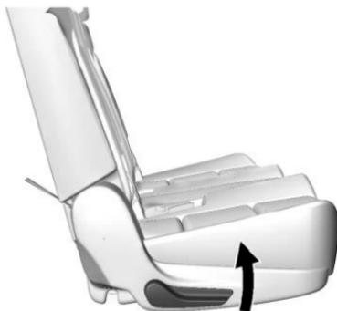
1. Lever le levier du côté extérieur du siège.
