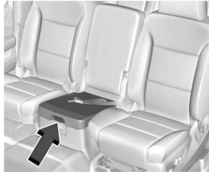
Si le véhicule est équipé d'un rangement de siège central, déverrouiller avec la clé de contact, appuyer sur le loquet et soulever pour ouvrir.
