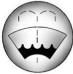
Enlever le bouchon marqué du symbole de lave-glace. Ajouter du liquide jusqu'à ce que le réservoir soit plein. Se reporter à *Aperçu du compartiment moteur* ⇨ 333 pour connaître l'emplacement du réservoir.
