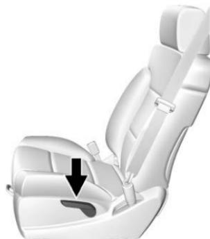
Pour régler un dossier de siège à commande manuelle :
