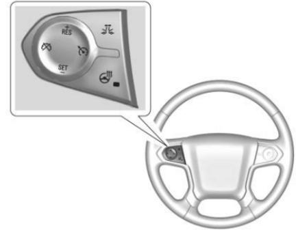
**Ⓜ** : Appuyer pour mettre le système en position de marche ou d'arrêt. L'indicateur devient blanc au groupe d'instruments lorsque la fonction ACC est tournée en position de marche.
