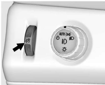
Ce dispositif contrôle l'intensité d'éclairage du tableau de bord et se trouve près de la commande d'éclairage extérieur.
