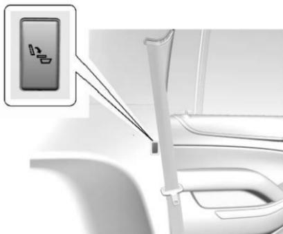
**Commutateur sur le panneau arrière côté conducteur**
