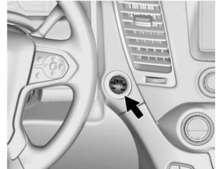
Les véhicules équipés d'un accès sans clé possèdent un démarrage à bouton-poussoir.
