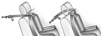
Si la position utilisée comporte un appui-tête fixe ou un appui-tête réglable et qu'une attache unique est utilisée, acheminer l'attache au retour de l'intérieur ou de l'extérieur de l'appui-tête.
