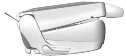
Le dossier de siège se replie vers l'avant pour crier un plancher plat de chargement.
