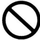
Une ligne diagonale en travers d'un cercle est un symbole de sécurité signifiant « Interdiction, »
