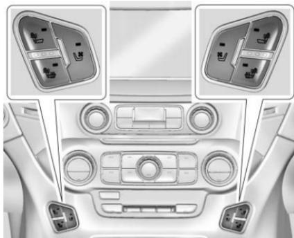
Les boutons se trouvent sur l'empilement central, sous le système de commande de climatisation. Pour fonctionner, le moteur du véhicule doit tourner.
