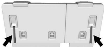
1. Depuis l'arrière du véhicule, redresser le dossier à l'aide de la sangle de traction placée au dos du siège, ou lever le dossier puis le pousser en place depuis l'intérieur du véhicule.
