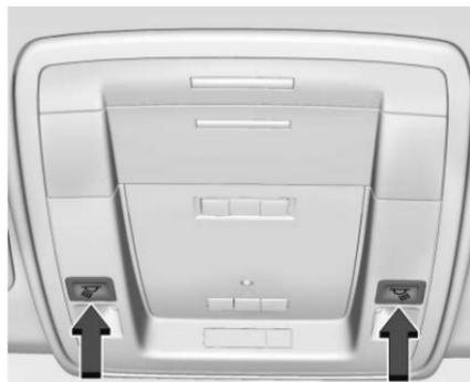
Des lampes de lecture sont logées dans la console de plafond et la garniture de pavillon, selon l'équipement. Pour les commander, le contact doit être mis sur ACC/ACCESSORY (accessoires), ou il faut utiliser l'alimentation prolongée des accessoires (RAP).
