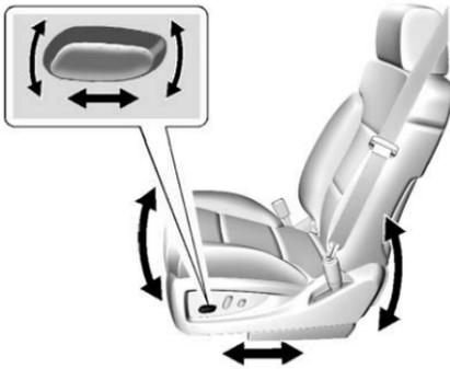
Pour ajuster un siège électrique, selon l'équipement :
