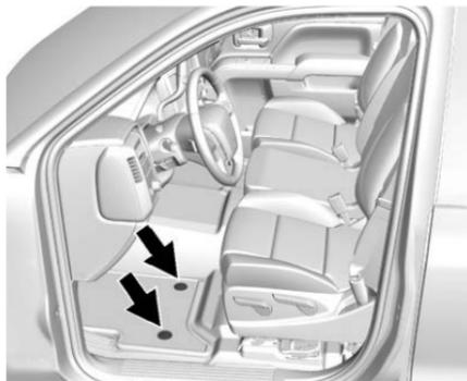
Réinstaller le tapis en plaçant les orifices sur les dispositifs de retenue et les emboîter en place.
