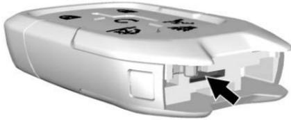
2. Lorsque la clé est déposée, introduire un objet plat et mince au centre de l'émetteur pour les séparer et déposer le couvercle du dos.
