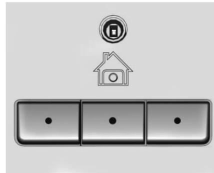
Si l'équipement comprend le système de télécommande universelle, ces boutons sont dans la console de plafond avant.
