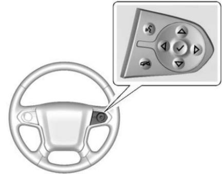
Certaines commandes audio peuvent s'effectuer au volant, si le véhicule est équipé en conséquence.
