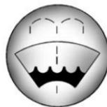
Enlever le bouchon marqué du symbole de lave-glace. Ajouter du liquide jusqu'à ce que le réservoir soit plein. Se reporter à *Aperçu du compartiment moteur* ⇨ 375 pour connaître l'emplacement du réservoir.
