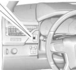
Pour étirer les deux marche-pieds électriques en vue du nettoyage, appuyer sur
