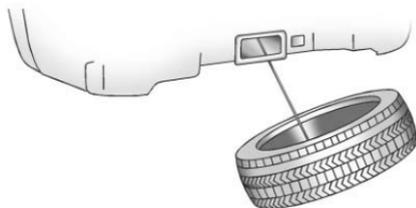
7. Incliner le pneu vers le véhicule avec un certain mou dans le câble pour accéder à la pièce
