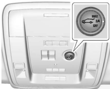
Selon l'équipement, le commutateur se trouve sur la console suspendue. Le véhicule doit occuper la position de stationnement (P).
