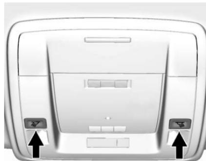
Des lampes de lecture équipent la console suspendue et la garniture de pavillon, en option. Pour les activer, le commutateur d'allumage doit occuper les positions ACC/
