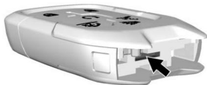
1. Lorsque la clé est déposée, introduire un objet plat et mince au centre de l'émetteur pour les séparer et déposer le couvercle du dos.
