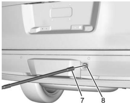
4. Insérer l'extrémité ouverte de la rallonge (7) dans l'orifice du pare-chocs arrière (8) (trou d'accès au treuil).
