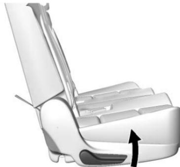
1. Lever le levier du côté extérieur du siège.
