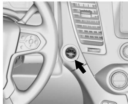
Les véhicules avec accès sans clé possèdent un démarrage à bouton-poussoir.
