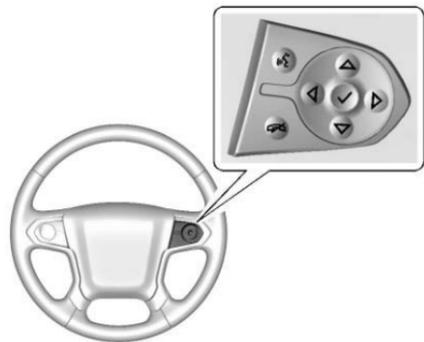
Utiliser la commande du volant du côté droit pour ouvrir et parcourir les différents éléments et affichages.
