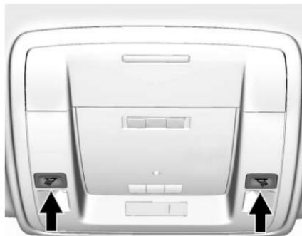
Des lampes de lecture peuvent équiper la console suspendue et la garniture de pavillon, en option. Pour les commander, le commutateur d'allumage doit occuper la position ACC/ACCESSORY (accessoires) ou ON/RUN (en fonction/marche), ou il faut utiliser l'alimentation prolongée des accessoires (RAP).
