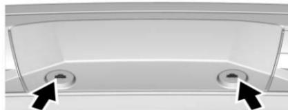
Si le véhicule est équipé d'une protection d'attelage, faire tourner les fixations de la protection dans le sens antihoraire et tirer le couvercle vers le bas pour le retirer avant de déposer la porte d'accès à l'axe du treuil.
