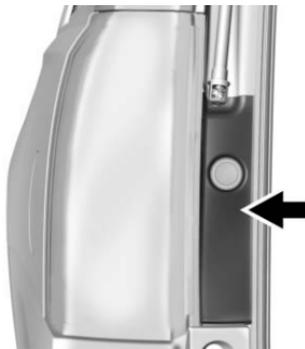
2. Retirer le couvercle de fermeture de feu arrière de l'ensemble de lampe en tirant vers l'arrière depuis le haut et le bas simultanément pour défaire les onglets qui se déboîtent.
