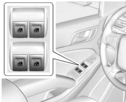
Les glaces fonctionnent lorsque le contact est en position ON/RUN (marche) ou ACC/ACCESSORY (accessoires), ou lorsque la Prolongation de l'alimentation des accessoires (RAP) est activée. Se reporter à *Prolongation d'alimentation des accessoires* ↪ 299.
