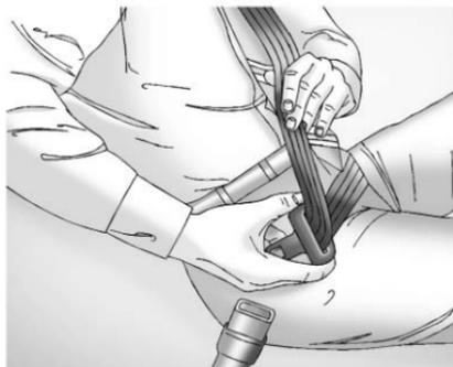
Pour les positions d'assise avant, si la sonde se bloque dans la plaque de verrouillage avant d'atteindre la boucle, incliner le méplat de la plaque de verrouillage pour le déverrouillage.
