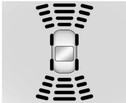
Le groupe d'instruments peut être équipé d'un affichage d'assistance au stationnement avec des barres qui indiquent la distance vers l'objet et l'information d'emplacement d'objet pour la fonction RPA et, sur certains véhicules, de la fonction FPA. En approchant de l'objet, davantage de barres s'éclairent et les barres changent de couleur, en passant du jaune à l'ambre et au rouge.
