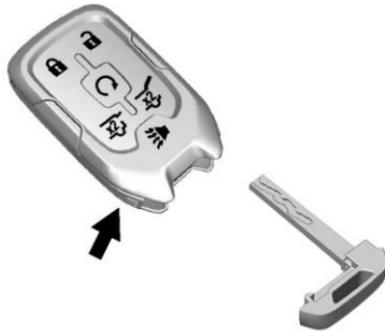
Si le véhicule est équipé d'un système d'accès sans clé, l'émetteur comporte un bouton sur le côté de l'émetteur utilisé pour enlever la clé. Ne pas tenter de retirer la clé sans appuyer sur le bouton.
