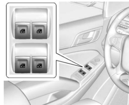
Les glaces fonctionnent lorsque le commutateur d'allumage est sur ON/RUN (en fonction/marche) ou ACC/ACCESSORY (accessoires), ou lorsque la prolongation de l'alimentation des accessoires (RAP) est activée. Se reporter à *Prolongation d'alimentation des accessoires* ⇨ 299.
