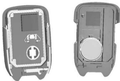
2. Soulever la pile au moyen d'un objet plat.
