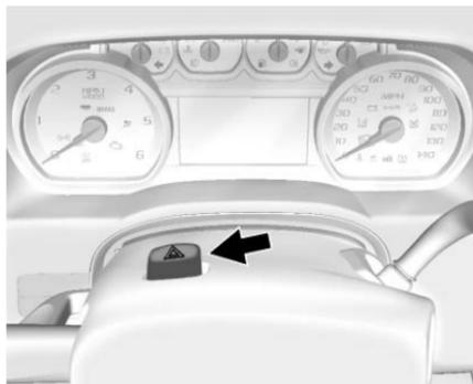
△ : Appuyer sur ce bouton pour mettre en marche les feux de détresse. Pour les arrêter, appuyer de nouveau sur le bouton.
