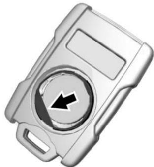
2. Presser et faire glisser la pile vers le bas en direction de la pochette de l'émetteur, dans le sens de l'anneau de la clé. Ne pas utiliser d'objet métallique.
