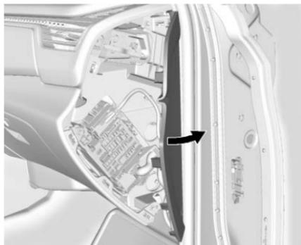
Le volet d'accès au bloc-fusibles du côté droit est sur le tableau de bord, côté passager.
