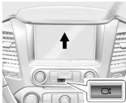
Si l'équipement comprend un compartiment de rangement derrière la radio, presser et maintenir
