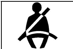
Le témoin de rappel de bouclage des ceintures de sécurité clignote quelques secondes, puis s'allume en continu quelques secondes supplémentaires.
