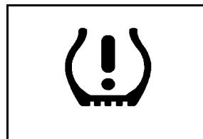
Sur les véhicules dotés d'une surveillance de pression des pneus, ce témoin s'allume brièvement lorsque le moteur démarre et fournit des informations sur les pressions des pneus et le système de surveillance de la pression des pneus.
