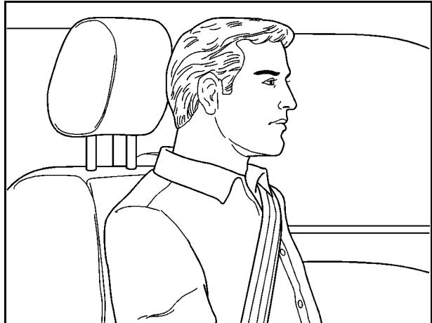
Régler l'appuie-tête de sorte que sa partie supérieure arrive au niveau du haut de la tête de l'occupant. Cette position réduit les risques de blessure à la nuque lors d'une collision.
