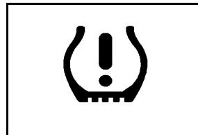
Le système nous avertit en cas de réduction significative de pression d'un ou plusieurs pneus du véhicule en éclairant le témoin de basse pression des pneus du tableau de bord.
