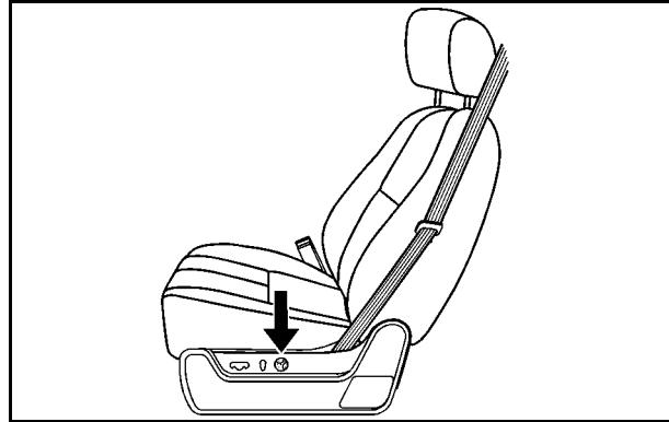
La commande se trouve sur le côté extérieur du siège (option).
