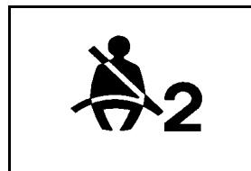
Cette séquence du carillon et du témoin est répétée si le passager ne boucle pas sa ceinture de sécurité et que le véhicule se déplace.
