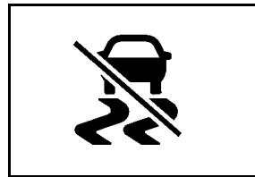
La commande de désactivation de la traction asservie se trouve sur le tableau de bord sous les commandes du climatiseur.
